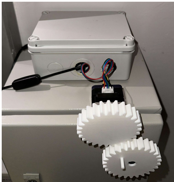
Figura 4-24 Mecanismo en su totalidad incorporado en el regulador.
