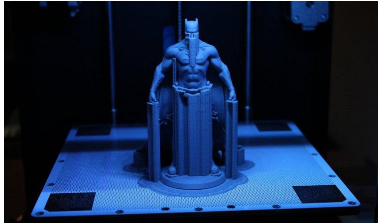
Figura 2-8. Figura de acción realizada mediante impresión 3D FDM.
