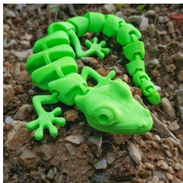
Figura 4-14. Ejemplo de figura articulada fabricada mediante impresión 3D.
