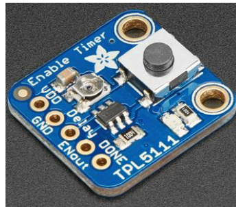
Figura 3-12. Dispositivo de bajo consumo, TPL5111 [74].
