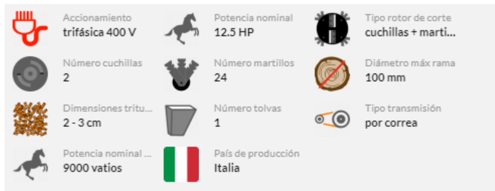
Figura 3-56 Características de la trituradora seleccionada [37].
