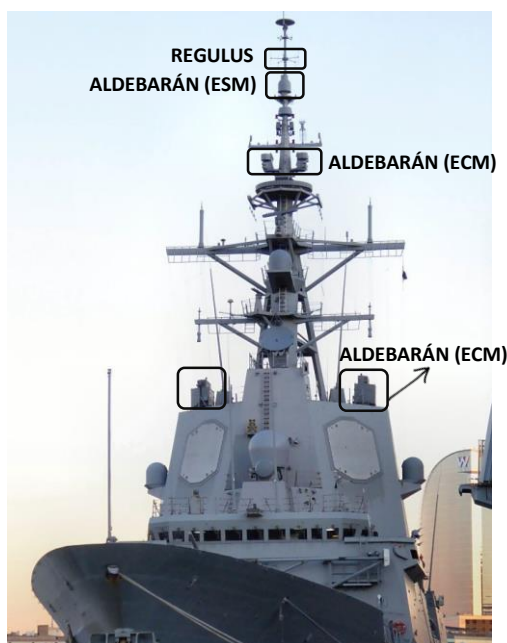
Figura 2-1 Detalle del mástil. Sistemas Aldebarán y Regulus instalados en las F-100 [6].
