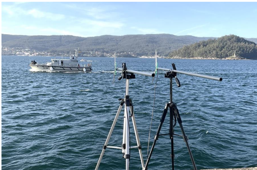
Figura 4-21 Antenas no directivas con la lancha GM Salas de fondo.
