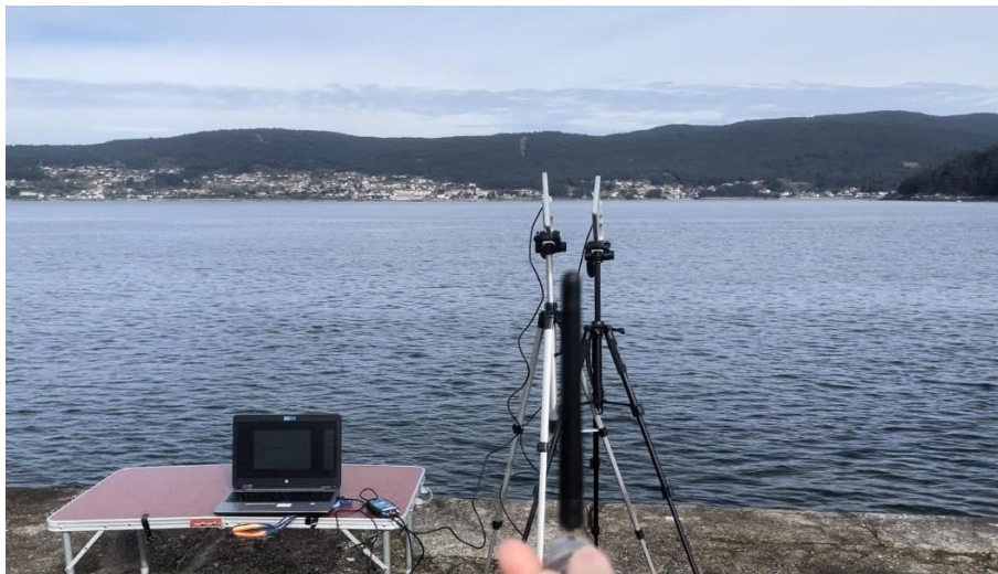
Figura 4-25 Comprobación antenas para transmisión 1 GHz.
