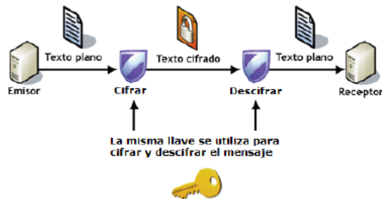
Figura 2-7 Secuencia de un cifrado simétrico [18]
