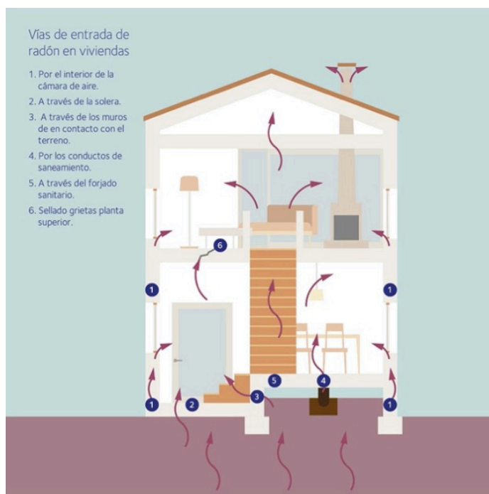
Figura 2-9 Vías de entrada de radón en viviendas (tomada de [47])
