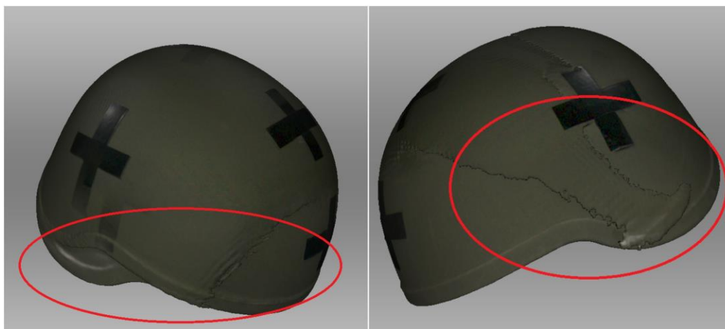
Figura 3-21 Fallos en el proceso de autoalineamiento
