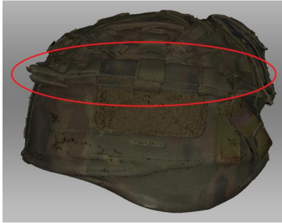
Figura 4-2 Fallos en el escaneado del casco con funda
