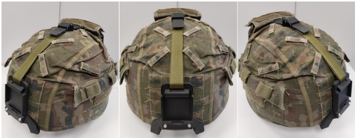
Figura 4-11 Nuevo atalaje creado colocado sobre casco COBAT 01
