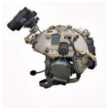
Figura 1-3 Casco configurado con visión nocturna, auriculares y micrófono y linterna [3]
