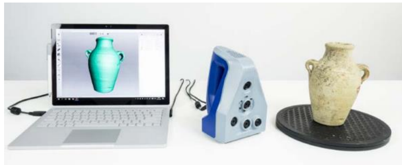
Figura 3-1 Visión general del proceso de escaneado mediante escáneres Artec
