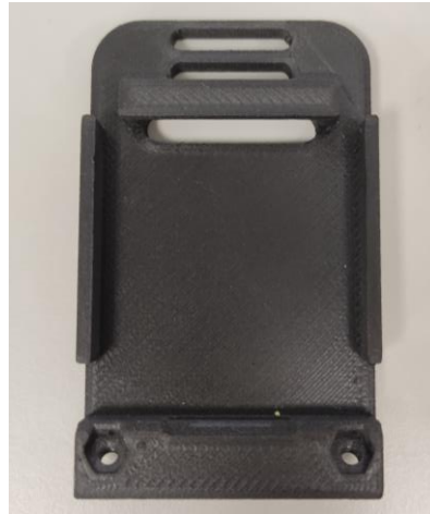
Figura 3-54 Placa de acople impresa con PET-CF
