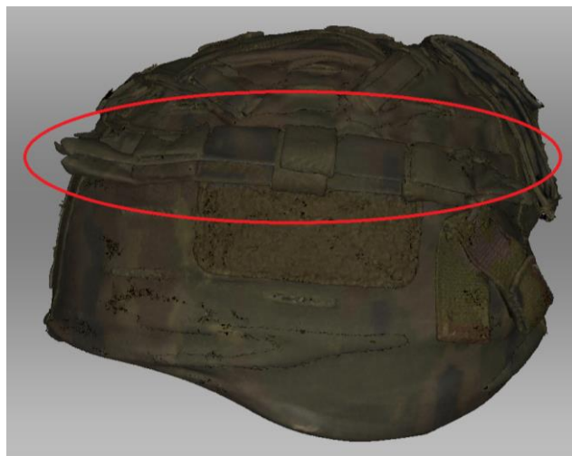
Figura 3-11 Imperfección en el escaneo
