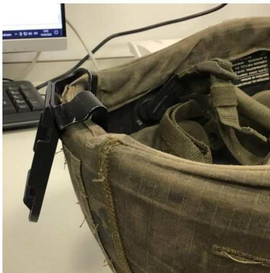
Figura 2-35 Incompatibilidad casco COBAT 01 con atalaje de PVS-14C [6]
