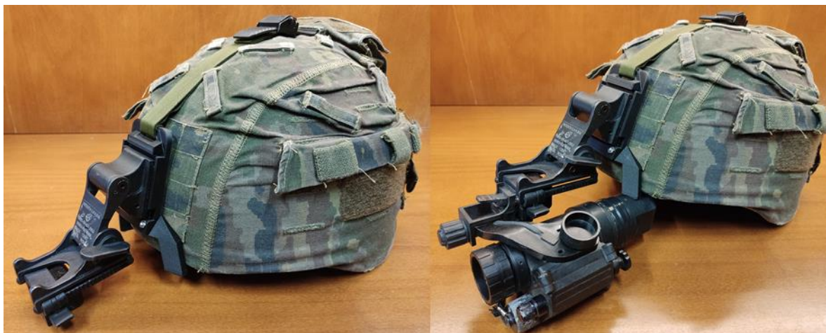
Figura 3-59 Modelo final con visor PVS-14C acoplado
