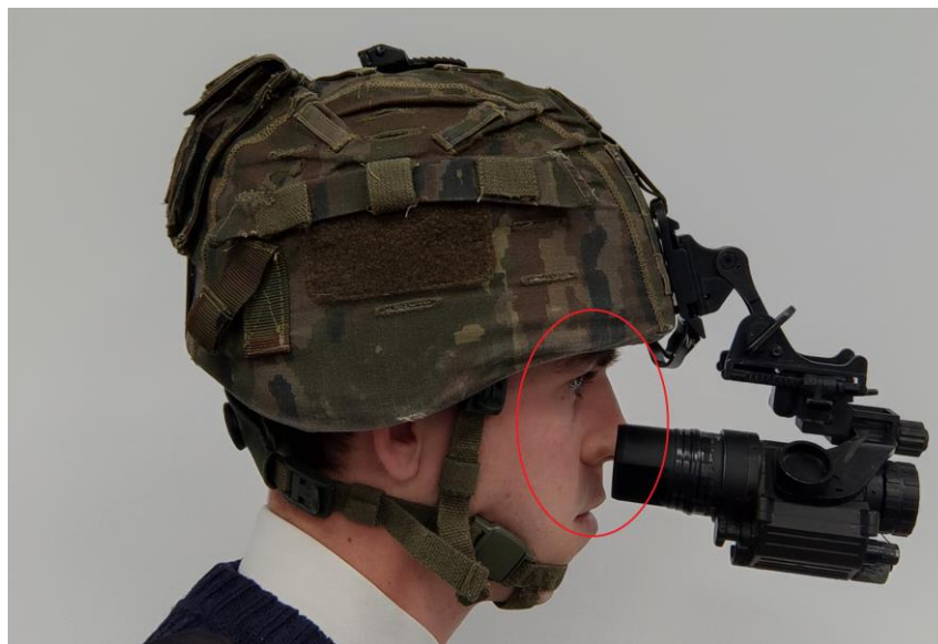
Figura 3-27 Imposibilidad de colocar PVS-14C a la altura de los ojos
