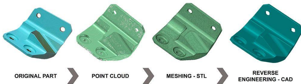
Figura 3-3 Proceso de ingeniería inversa a través de escaneo 3D [55]
