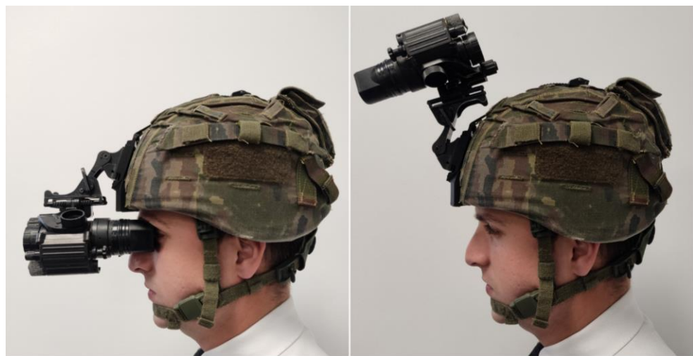
Figura 4-16 Colocación del PVS-14C en posiciones distintas (II)
