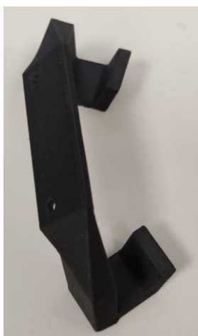
Figura 3-56 Uñas frontales impresas con PET-CF
