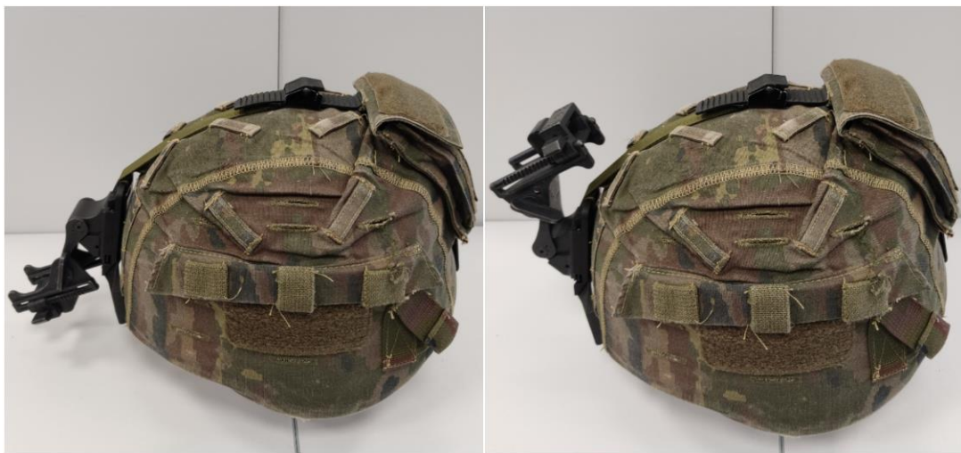
Figura 4-12 Nuevo atalaje creado con "Brazo Rhino" en diferentes posiciones
