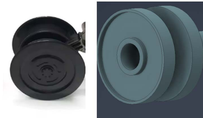
Figura 3-14 Rueda conducida superior: (izquierda) pieza original del vehículo, (derecha) modelo CAD
