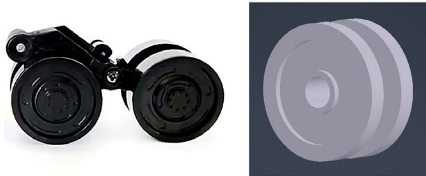
Figura 3-15 Rueda conducida inferior: (izquierda) pieza original del vehículo, (derecha) modelo CAD
