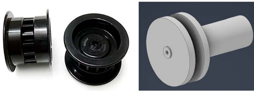
Figura 3-16 Rueda motriz: (izquierda) pieza original del vehículo, (derecha) modelo CAD
