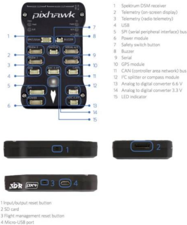
Ilustración 4-32 - Conectores Pixhawk (fuente [2])
