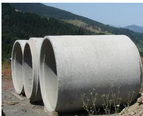
Figura 4-3 - Tubo machihembrado de hormigón armado. Adaptado de [38]
