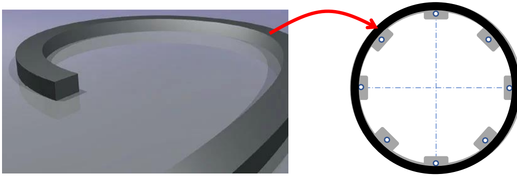
Figura 4-4 - Junta elástica de estanqueidad para tubo de hormigón comercializada por Algaher [39]
