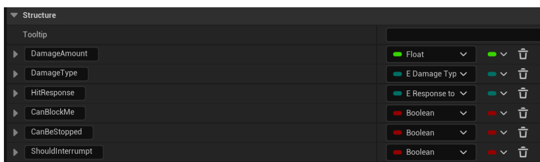
Figura 3-49 Variables de la estructura E_DamageInfo (Autoría propia).
