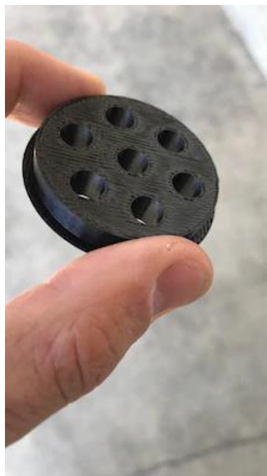
Figura 2-11 Tapón de drenaje diseñado mediante Fabricación Aditiva [9].
