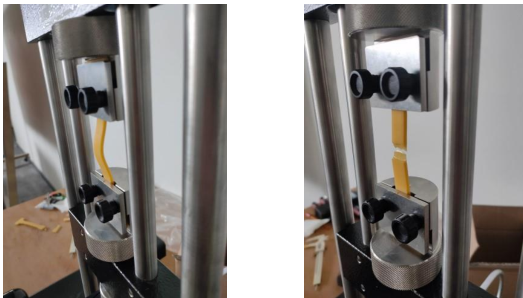
Figura 3-14 Momentos de pandeo y rotura de los ensayos
