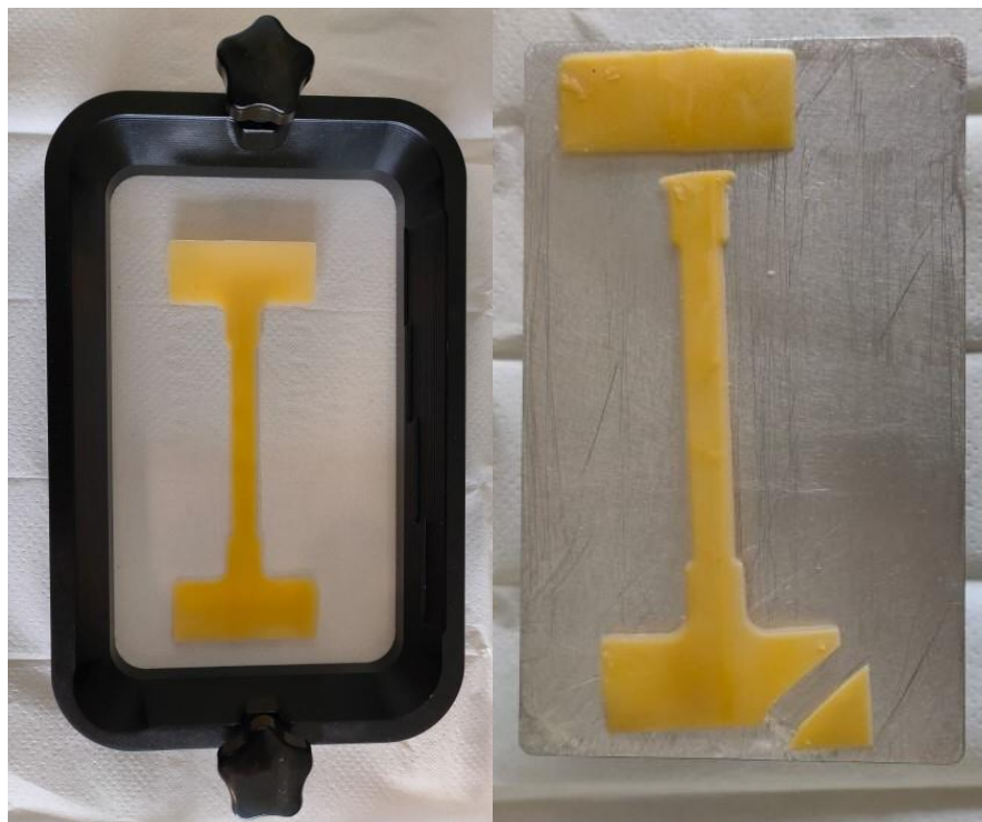
Figura 3-13 Fallos en la impresión de los nuevos diseños
