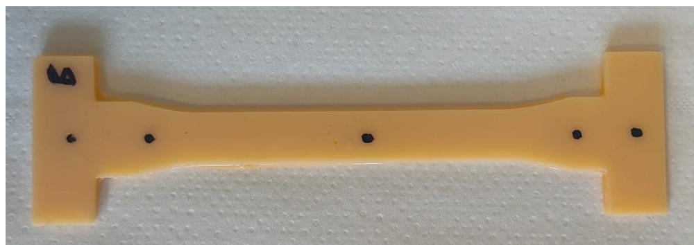
Figura 3-15 Probeta utilizada en los ensayos de dureza
