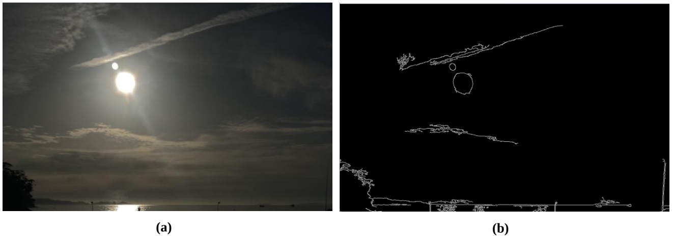
Figura 4-1 Ejemplo de detección de bordes con cielo parcialmente cubierto (a) Imagen original (b) Bordes detectados con Canny
