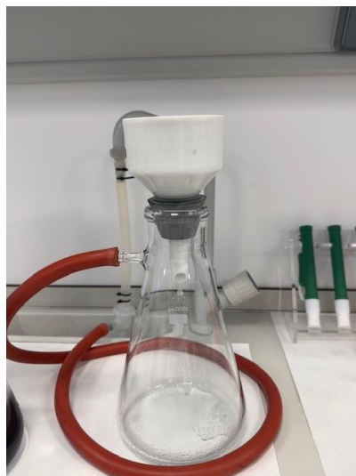
Figura 3-2 Embudo Büchner/Sistema Kitasato [Autoría propia]
