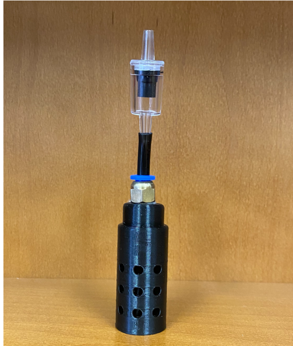
Figura 3-19 Capsula parcialmente cerrada con válvula antirretorno
