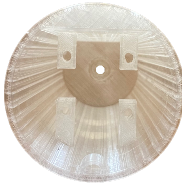
Figura 3-33 Interior de la primera pieza del tubo de medición
