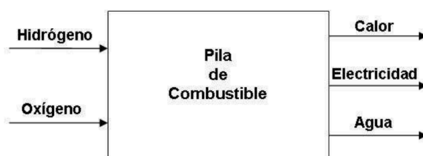
Figura 2-7 Entrada y salida de una célula de combustible de hidrógeno [19]
