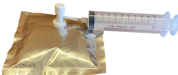
Figura 3-15 Bolsa estanca con H_2 y jeringuilla
