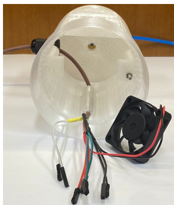
Figura 4-1 Cableado del interior del tubo de medición
