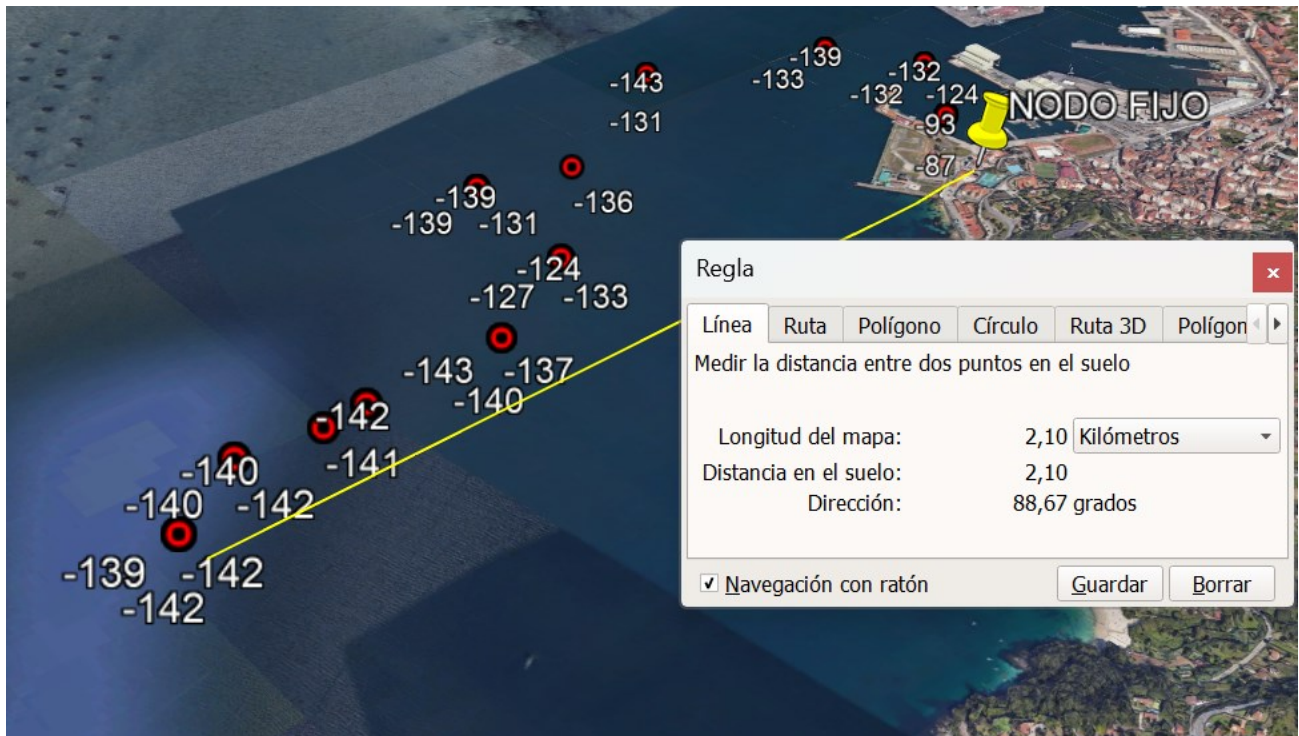
Figura 5-11 Prueba de alcance con la antena grande y sus RSSI (dB).
