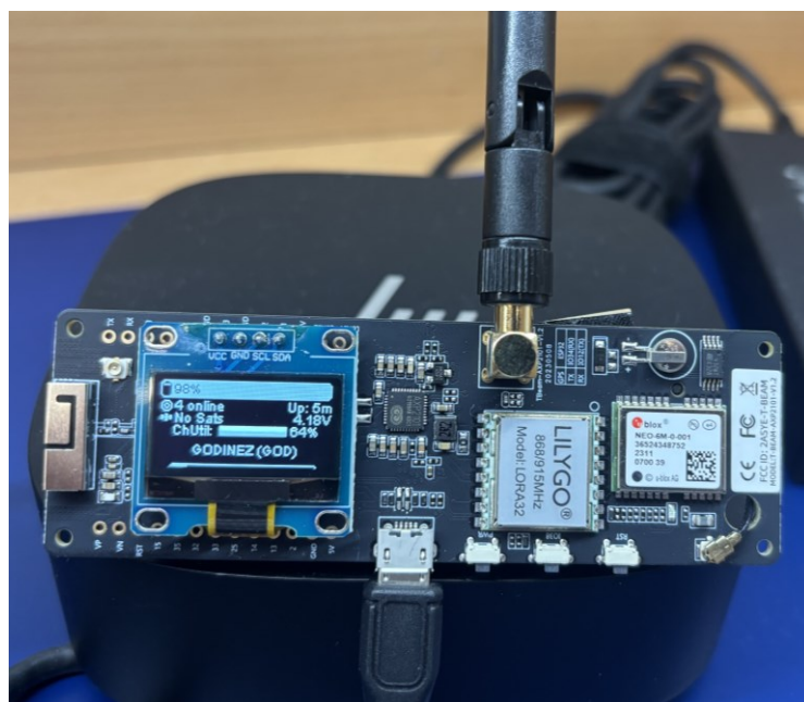
Figura 5-13 Pantalla OLED del nodo que muestra el uso del canal.
