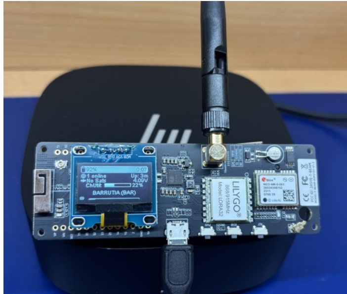
Figura 5-14 Uso del canal al enviar un mensaje SACOMAR con la configuración Medium Fast .
