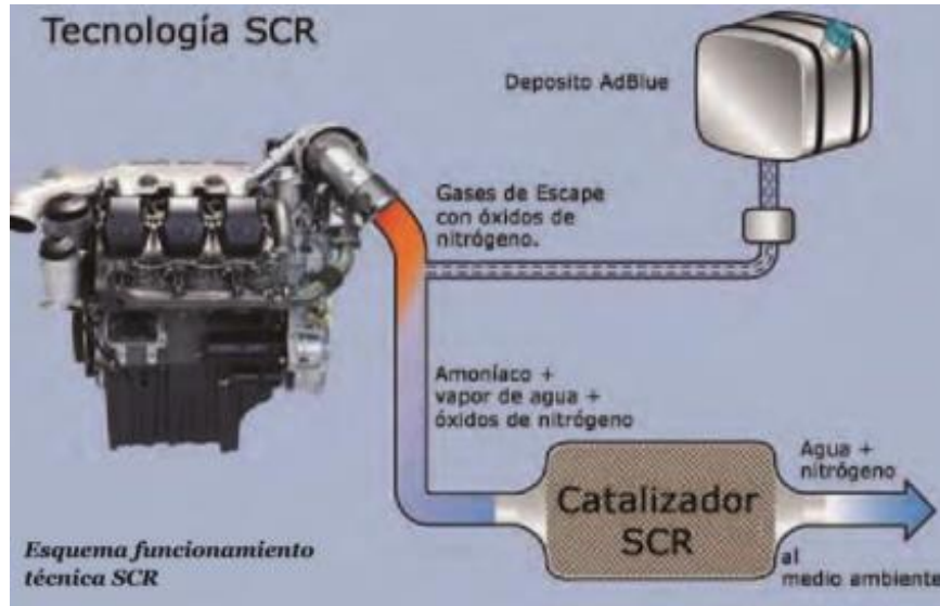
Figura 4-25 Esquema Reducción Catalítica Selectiva [98]
