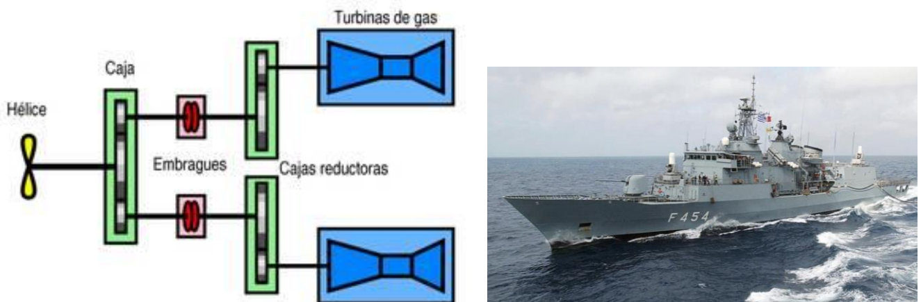
Figura 2-20 Esquema COGAG [46] y fragata MEKO 200 HN griega [50]
