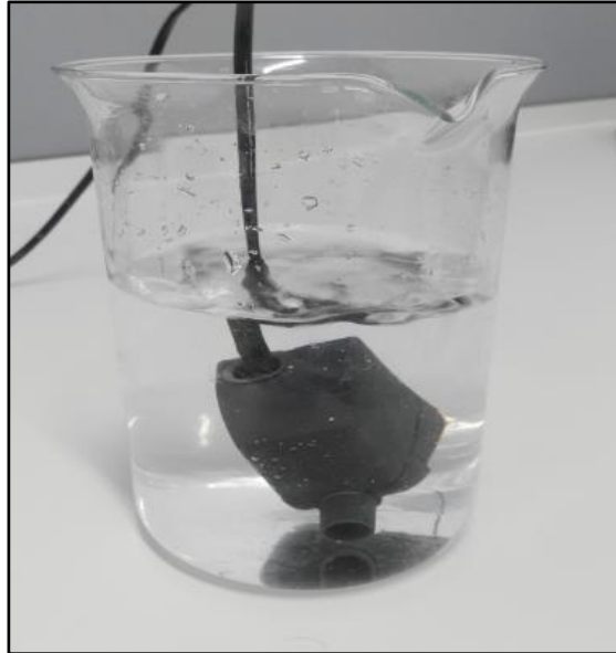
Figura 3-29 Bomba de agua empleada en los ensayos realizados con agua destilada como único fluido refrigerante.
