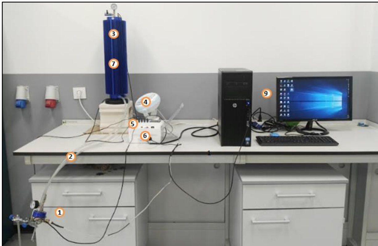
Figura 3-2 Elementos utilizados en el sistema de refrigeración.
