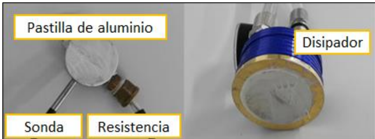
Figura 3-11 Aplicación de la pasta térmica WLPK-J3 en los componentes utilizados en los ensayos.
