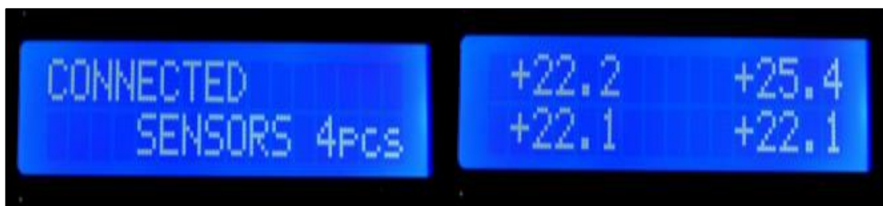
Figura 3-13 Ejemplo de funcionamiento del registrador de temperaturas en configuración y obteniendo datos.
