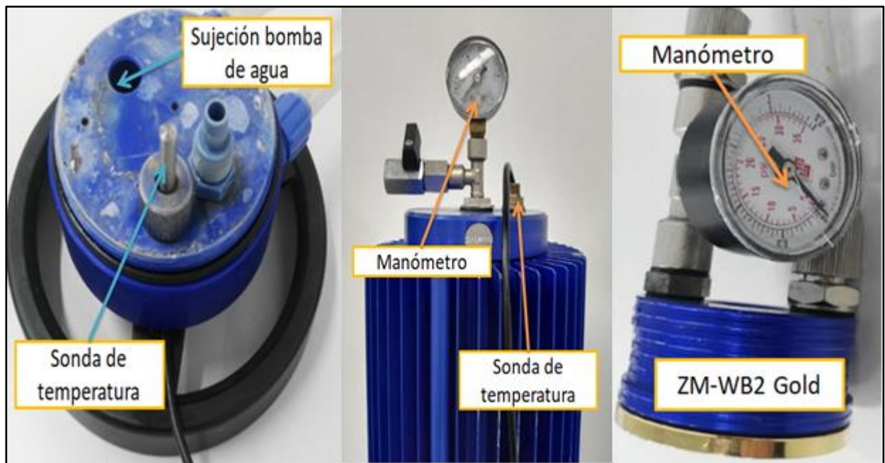
Figura 3-20 Elementos modificados respecto al sistema de refrigeración inicial Reserator1.
