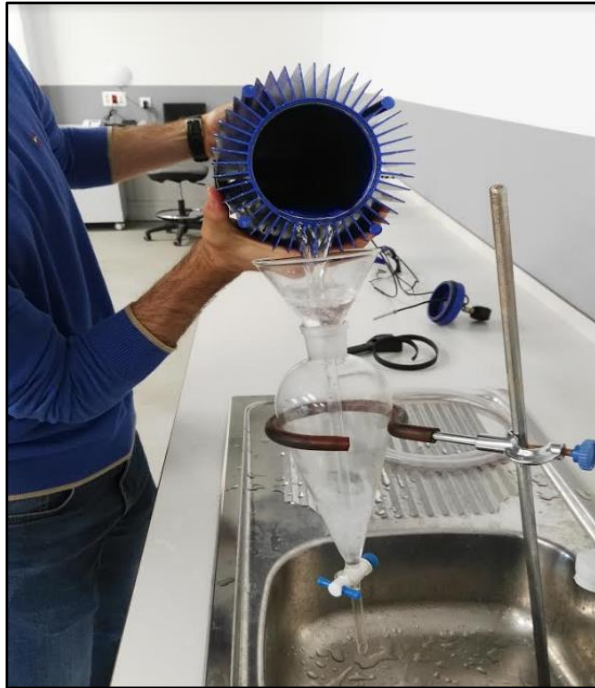
Figura 3-27 Decantación realizada en el cambio de fluidos refrigerantes.
