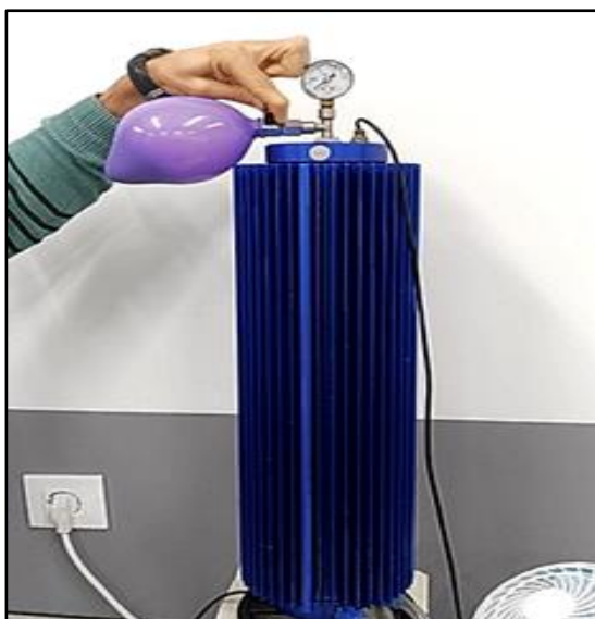
Figura 3-28 Realización de vacío del sistema.
