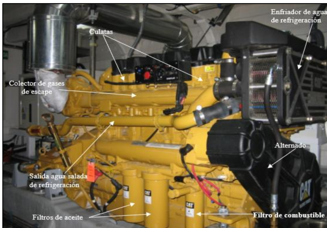
Figura 2-16 Sistema de refrigeración en los motores diésel de las lanchas de instrucción [37].
