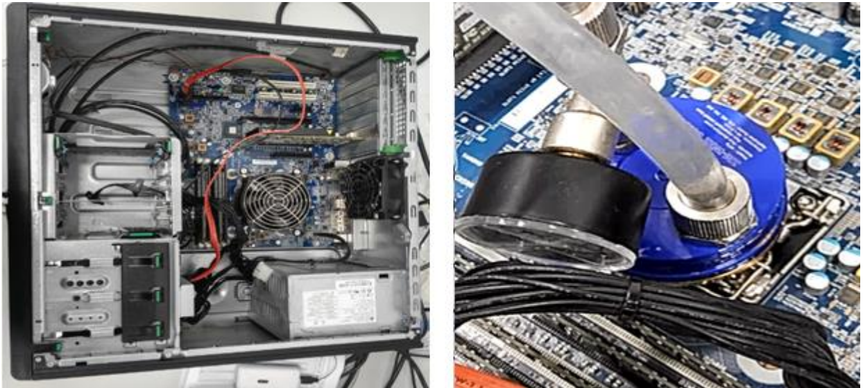
Figura 3-31 Elementos utilizados en el ensayo sobre CPU.
