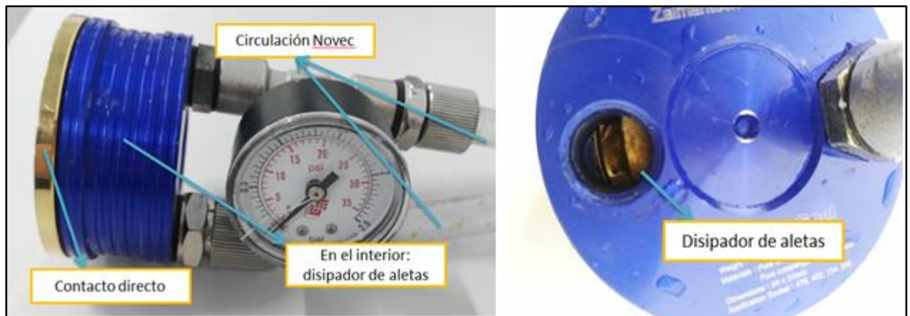
Figura 3-4 Contacto directo con el elemento a enfriar y disipador interno.
