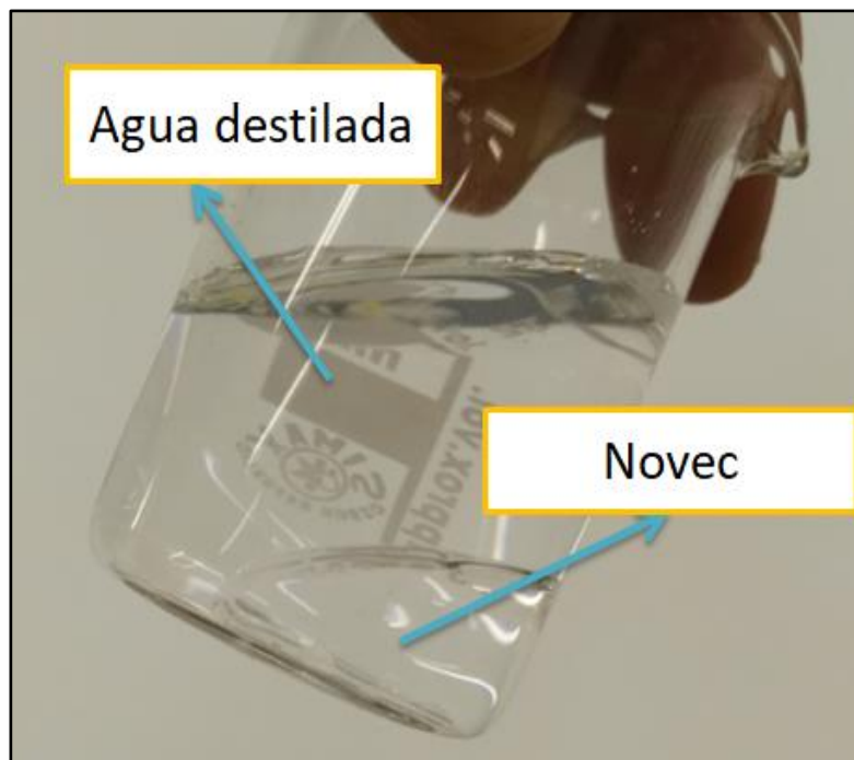
Figura 3-15 Demostración de la inmiscibilidad de los fluidos a pesar de ser removidos.
