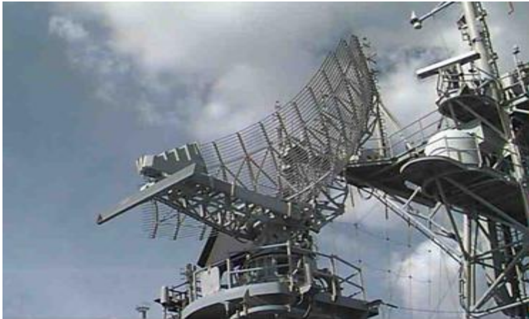
Figura 2-17 Radar de exploración aérea AN/SPS-49(V)4.
