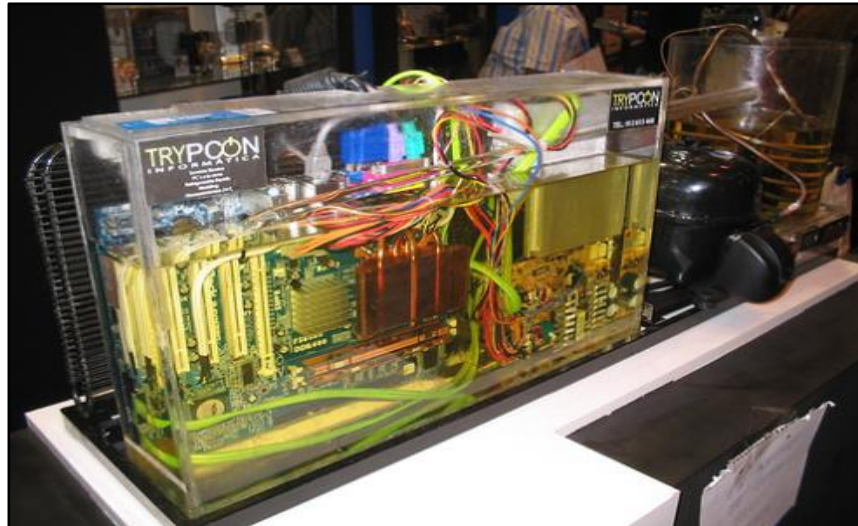
Figura 2-5 Sistema de refrigeración de una fase en inmersión con aceite [29].
