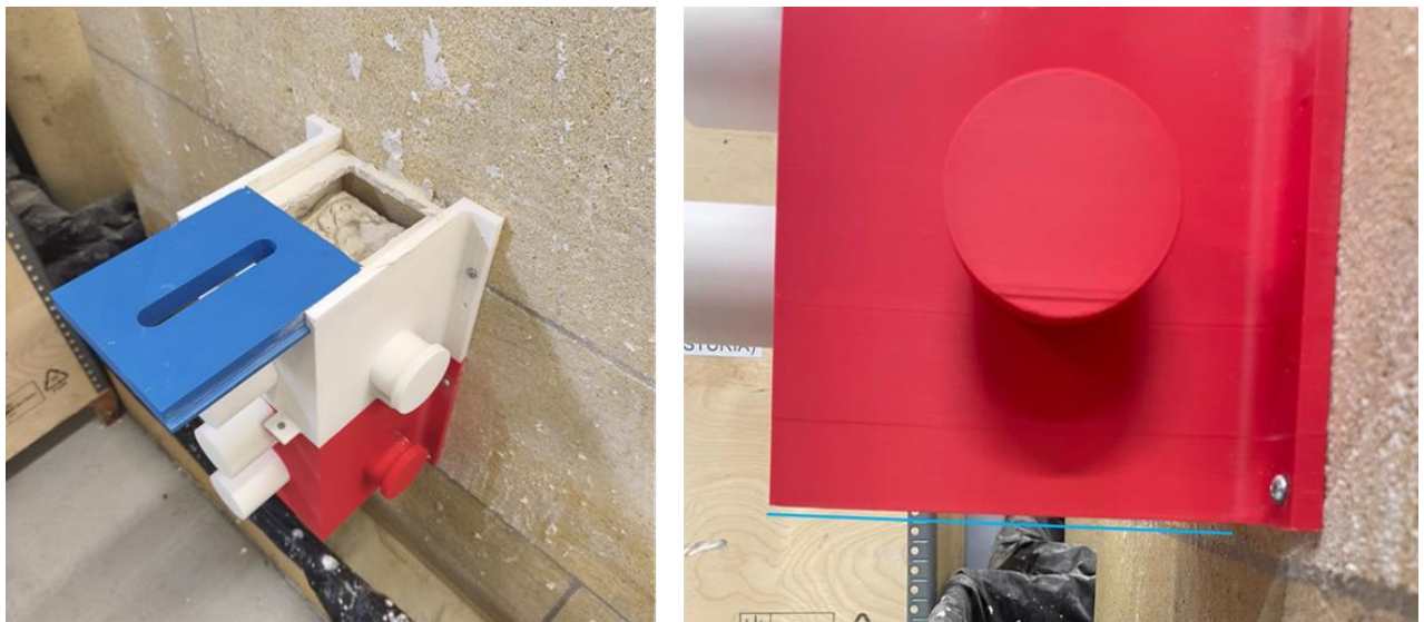
Figura 4-10 Imagen tomada 10 días después de la prueba de carga, con el contenido lleno con 9,3kg de arcilla. Se aprecia la pérdida de volumen de la arcilla que ya no está en contacto con el muro y se compara con una línea recta en su parte inferior para ver el nulo desplazamiento aparente de la superficie del armazón
