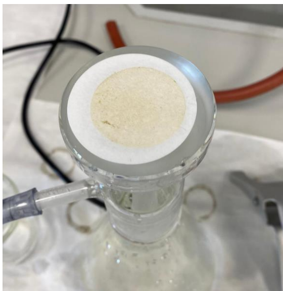
Figura 3-11 Filtro tras filtrar aguas de salida de la F-105.
