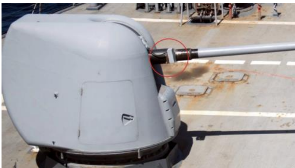
Figura 2-13. Radar doppler en el cañón Mk-45 de las F100 [19].
