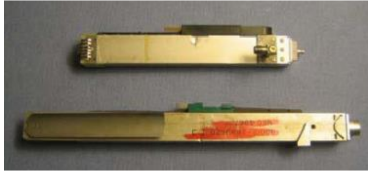
Figura 3-14. Elemento radiante fijo del array [31].
