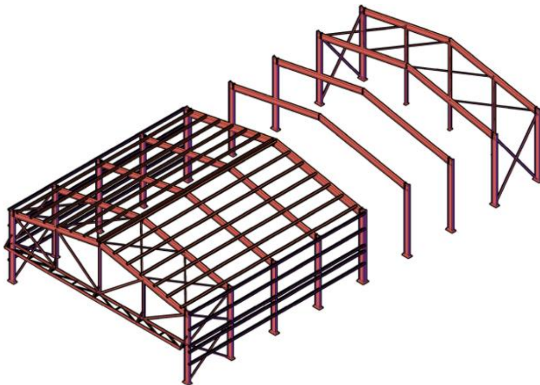
Figura 3-3 Vista 3D esquemática de la estructura con ocultación parcial de correas.
