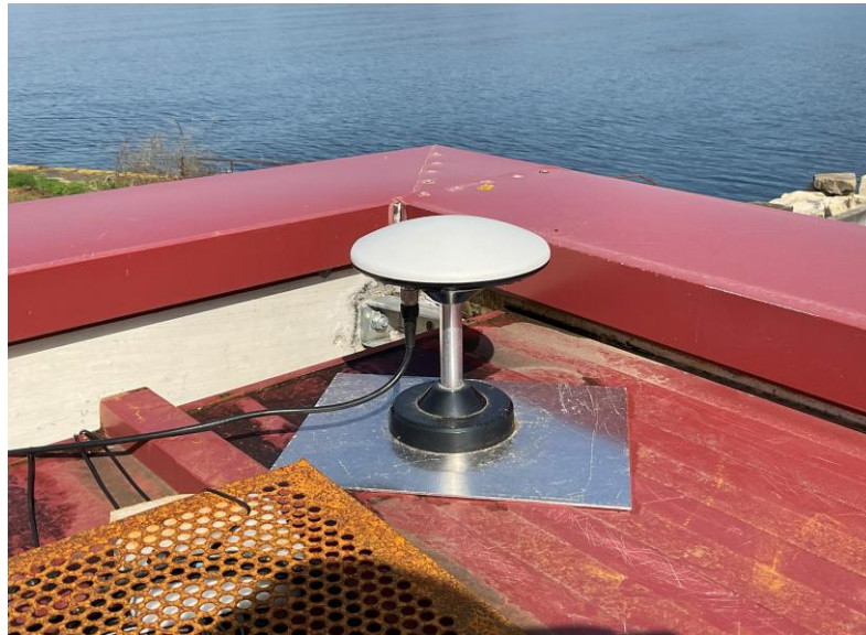
Figura 4-3 Antena real tipo “patch” (Fuente: MATLAB)
