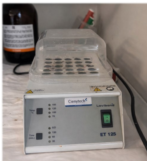
Figura 3-19. Bloque digestor empleado para la etapa de digestión térmica en la determinación de nitrógeno y fósforo totales y DQO.
