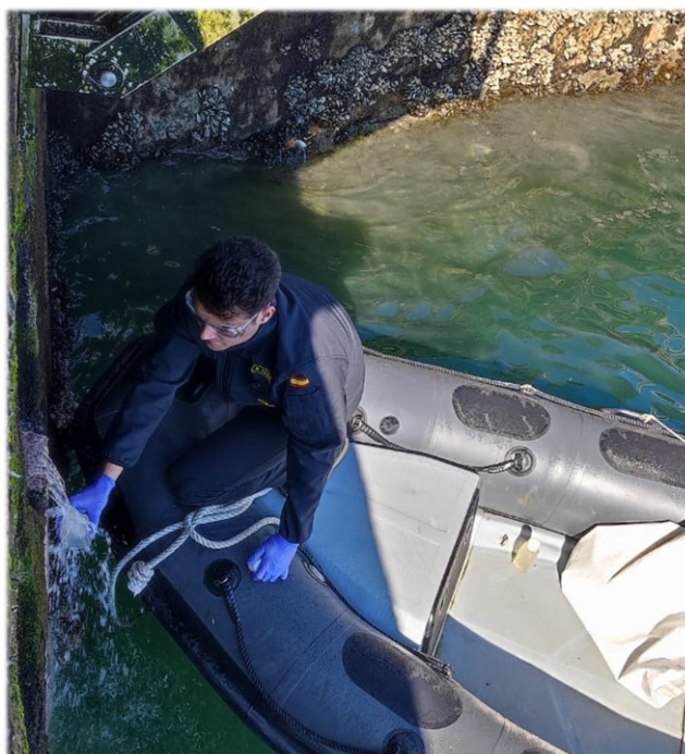
Figura 3-14. Toma de muestra en el punto de descarga del aliviadero mediante embarcación semirrígida.
