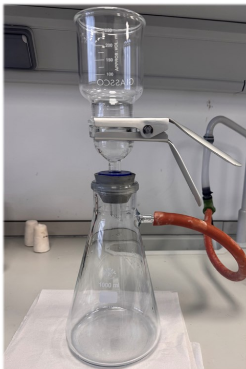
Figura 3-16. Sistema de filtración a vacío empleado para la determinación de sólidos en suspensión y análisis microbiológico por filtración de membrana.
