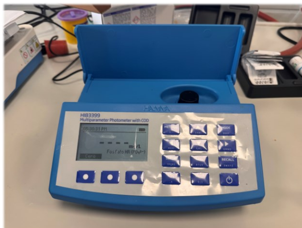
Figura 3-18. Fotómetro multiparámetro empleado para la determinación espectrofotométrica de nutrientes.
