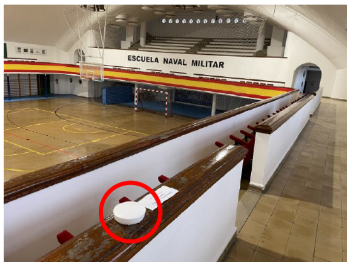
Figura 3-17 Sensor Wave Plus situado en el pabellón [Autoría propia]
