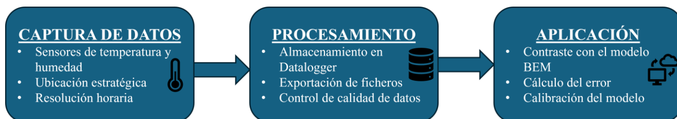
Figura 3-4 Esquema del flujo de trabajo para la monitorización y adquisición de datos térmicos. Fuente: Elaboración propia
