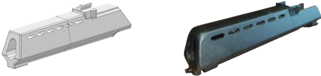
Figura 3-26 Comparación Guardamanos diseñado – Guardamanos real
