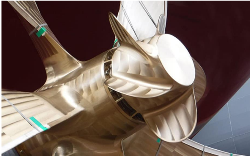
Figura 4-14. Hélice con dispositivo PBCF [36].
