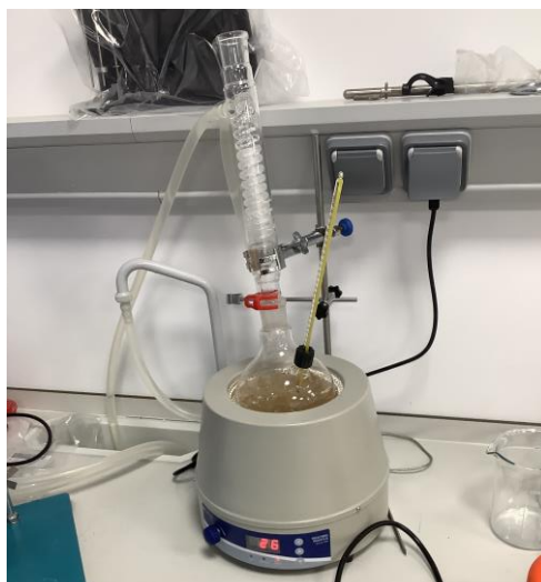
Figura 3-3 Montaje de manta calefactora y refrigerante utilizado en el proceso de medición de lignina
