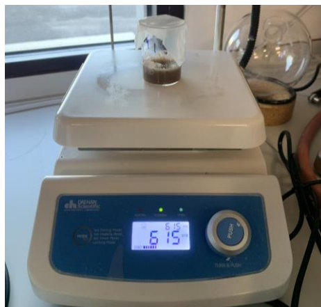
Figura 3-2 Agitación de la mezcla a 615 rpm
