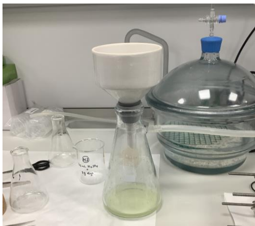
Figura 3-7 Estación de filtrado para la separación de sólidos en la obtención de holocelulosa
