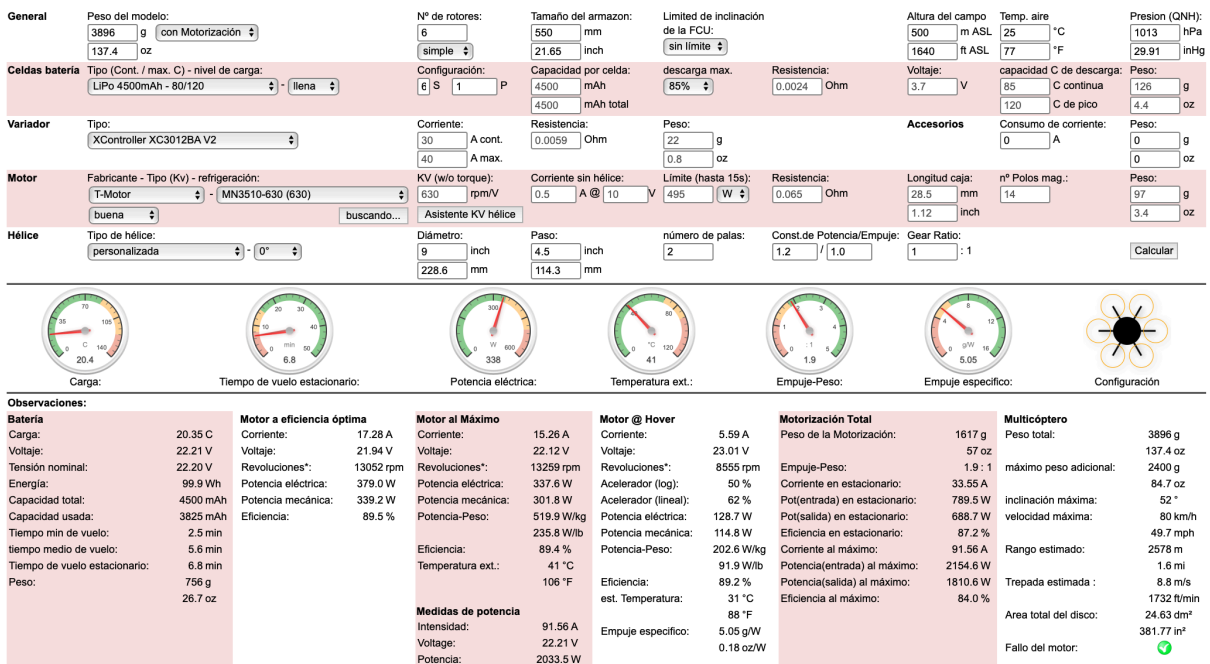
Figura A2 - 2: Resultados Ecalc para la simulación de motor eléctrico, pila de combustible y batería a 24 V
