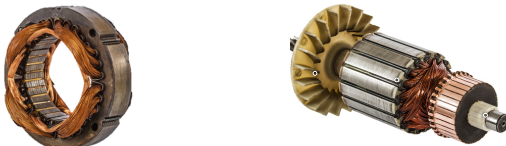
Figura 3-2: Estator (izquierda) y rotor (derecha) de un motor eléctrico
