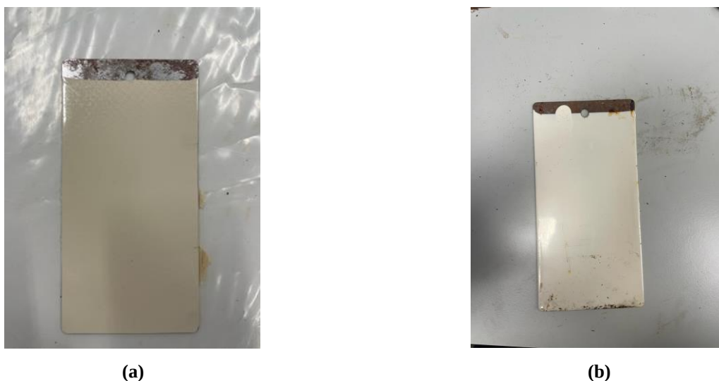
Figura 4-31 (a) Antes y (b) después pintura blanca en inmersión en agua desionizada (elaboración propia)
