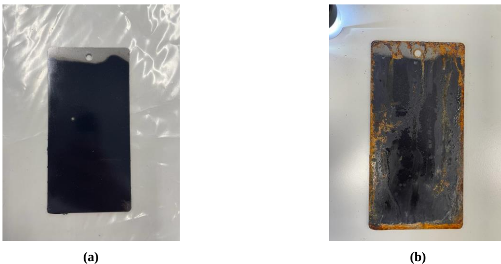
Figura 4-1 (a) Antes y (b) después Hempel Ecopower Prop en niebla salina (elaboración propia)
