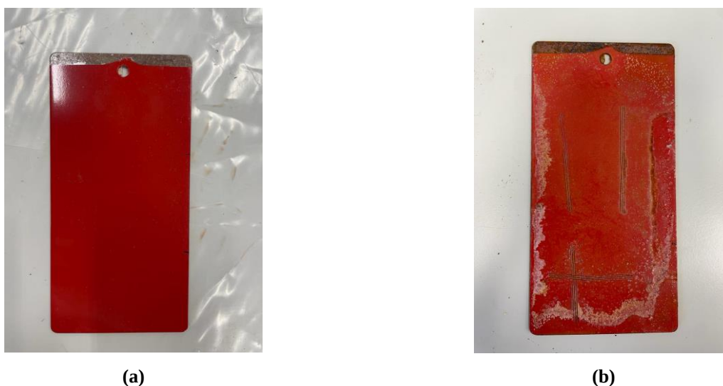
Figura 4-13 (a) Antes y (b) después pintura roja en inmersión salina (elaboración propia)
