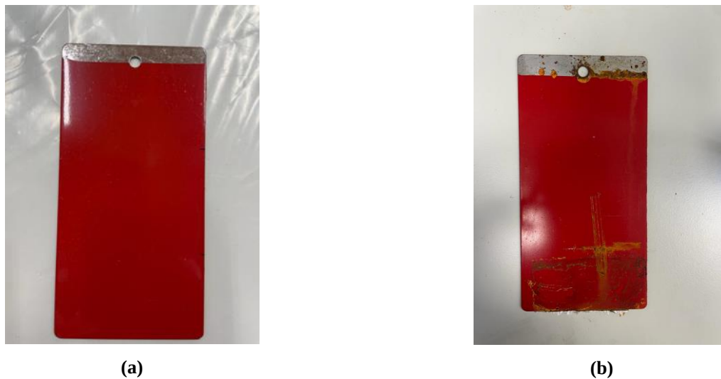
Figura 4-21 (a) Antes y (b) después pintura roja en niebla de agua desionizada. (elaboración propia)
