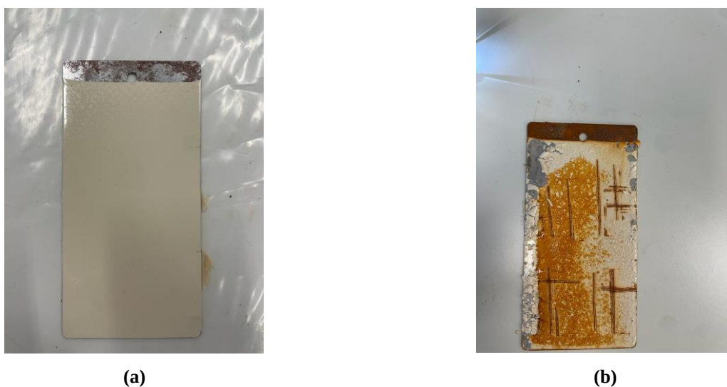
Figura 4-15 (a) Antes y (b) después pintura blanca en inmersión salina (elaboración propia)
