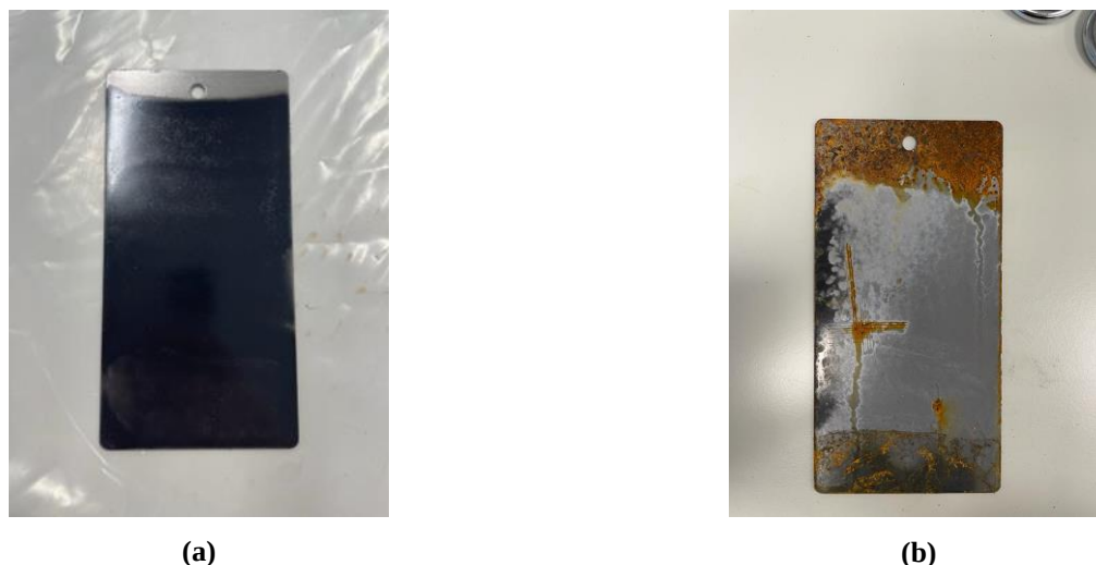
Figura 4-19 (a) Antes y (b) después Immasa Marine Print en niebla de agua desionizada (elaboración propia)
