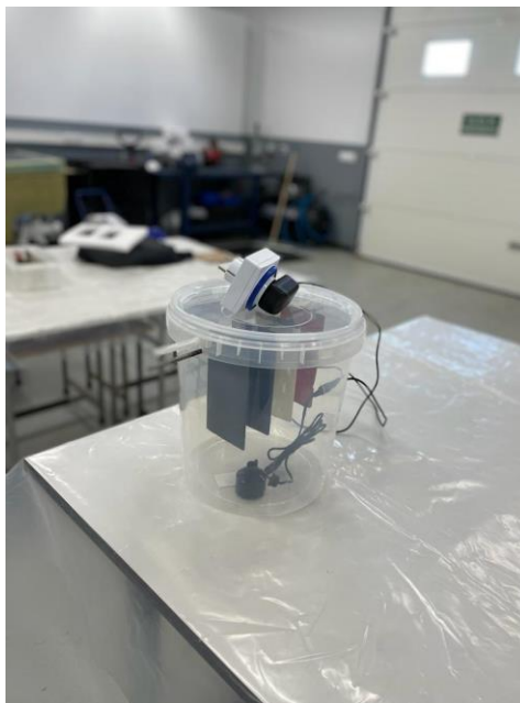
Figura 3-6 Cámara de niebla salina empleada (elaboración propia)
