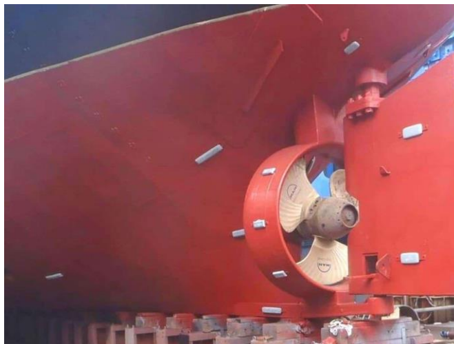
Figura 2-9 Ánodos de sacrificio en un barco [18]
