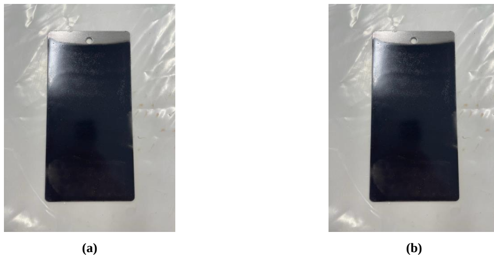
Figura 4-3 (a) Antes y (b) después Imnasa Marine Print en niebla salina (elaboración propia)
