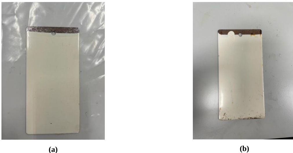
Figura 4-23 (a) Antes y (b) después pintura blanca en niebla de agua desionizada (elaboración propia)
