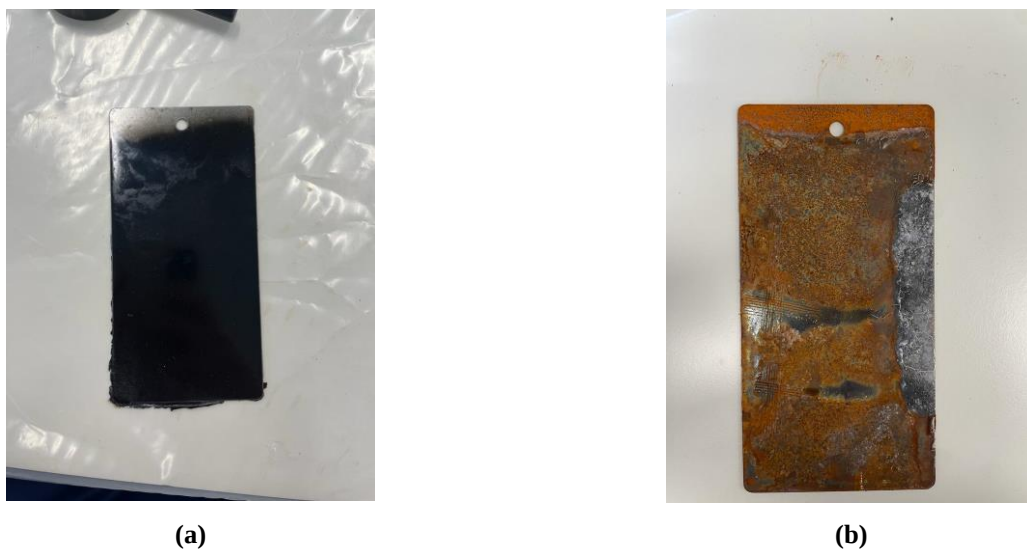
Figura 4-11 (a) Antes y (b) después Imnasa Marine Print en inmersión salina (elaboración propia)
