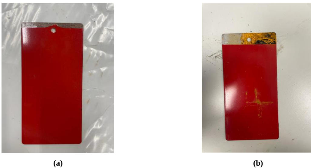
Figura 4-29 (a) Antes y (b) después pintura roja en inmersión en agua desionizada (elaboración propia)
