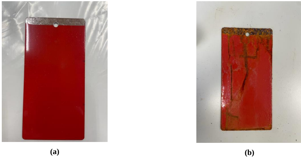
Figura 4-5 (a) Antes y (b) después pintura roja en niebla salina (elaboración propia)
