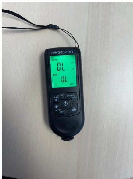
Figura 3-2 Medidor de espesores (elaboración propia)
