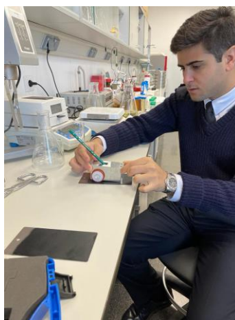
Figura 3-9 Realización de ensayo de dureza por lápiz (elaboración propia)
