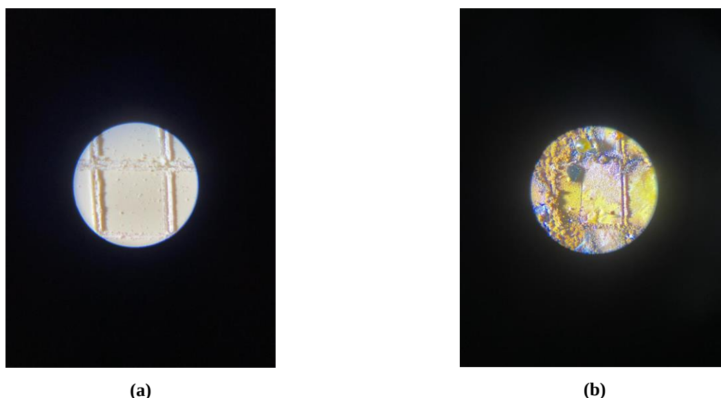
Figura 4-16 (a) Antes y (b) después corte pintura blanca en inmersión salina (elaboración propia)
