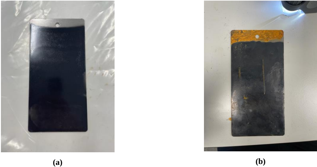
Figura 4-25 (a) Antes y (b) después Hempel Ecopower Prop en inmersión en agua desionizada (elaboración propia)
