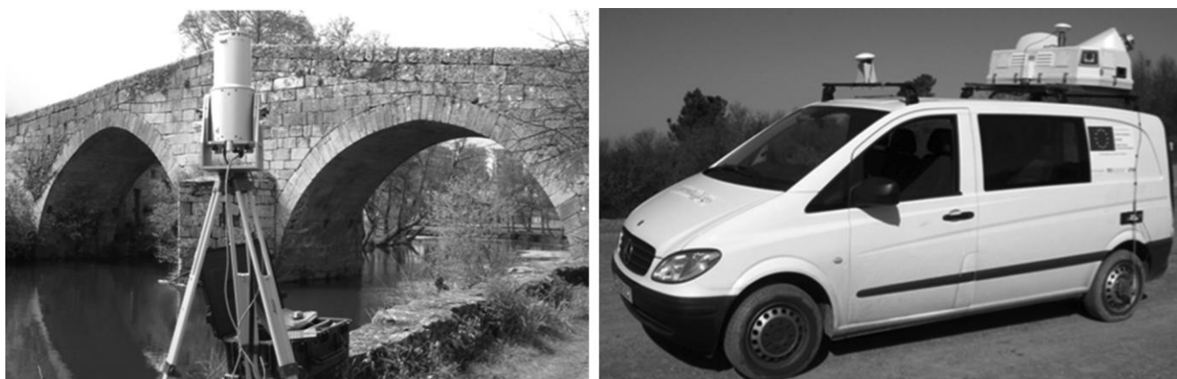
Figura 2-12 Ejemplos de dispositivos LiDAR. Láser escáner terrestre Marca Rieg, modelo LMS Z-390-i (izquierda) y láser escáner móvil montado sobre vehículo para mapeado de carreteras de marca Lynx [8]
