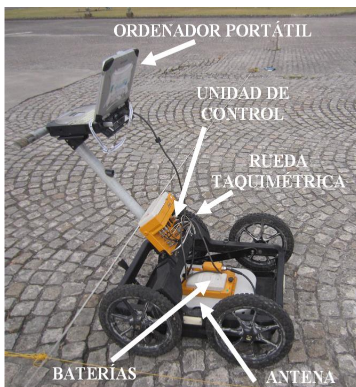
Figura 2-7 Componentes de un georradar
