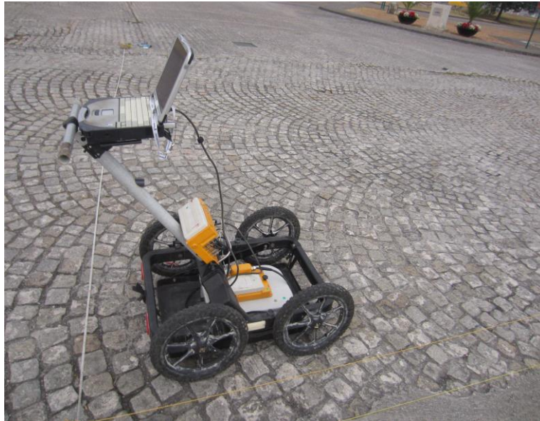
Figura 3-3 Equipo GPR empleado para la toma de datos
