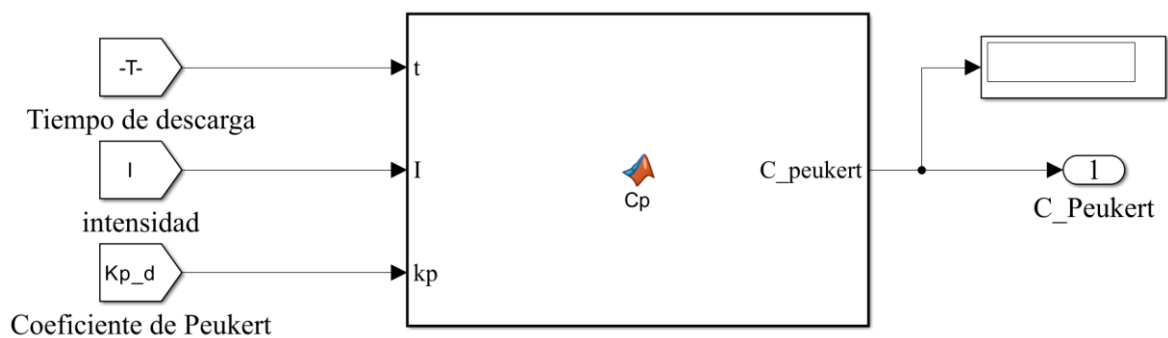
Figura 3-5. Bloque de cálculo de la capacidad de Peukert [Fuente propia].
