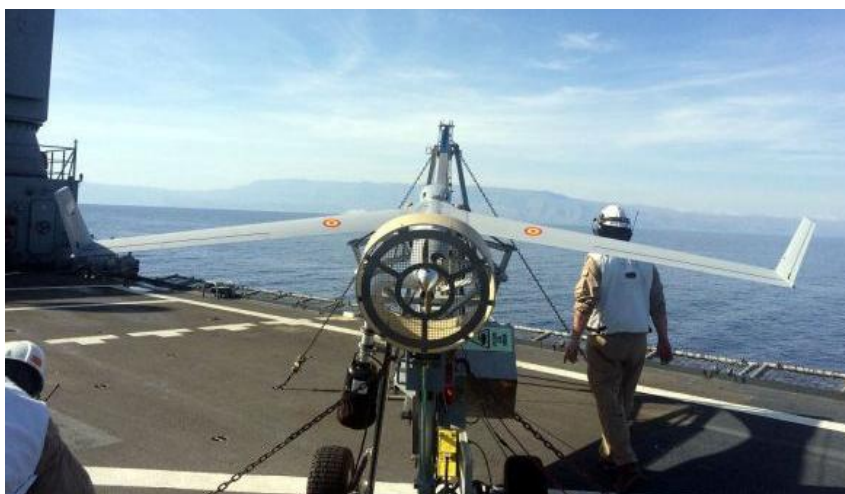
Figura 2-2 Lanzamiento de dron ScanEagle desde buque [20]
