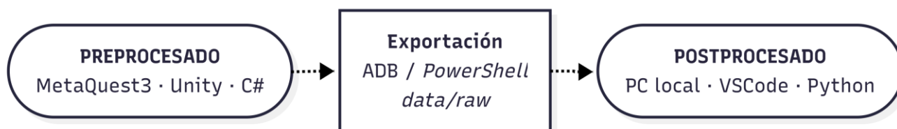
Figura 3-6: Diagrama de flujo. Bloques funcionales del sistema (Autoría propia)
