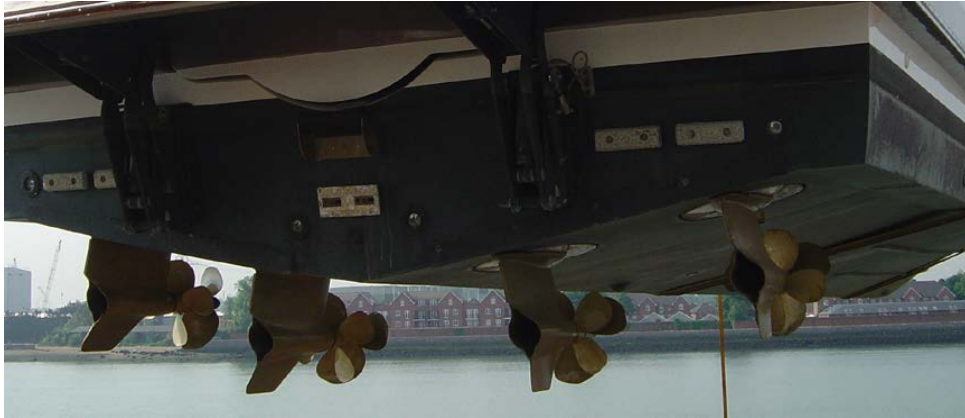
Figura 80. Instalación cuádruple de Volvo Penta IPS en casco plano [75]
