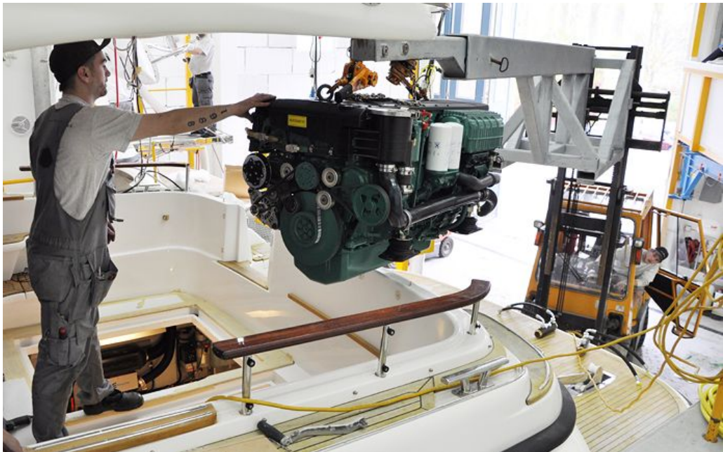
Figura 89. Introducción del motor por cesárea en un yate civil [83]
