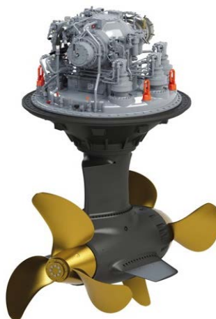
Figura 36. Siemens Schottel STP 4000 [40]
