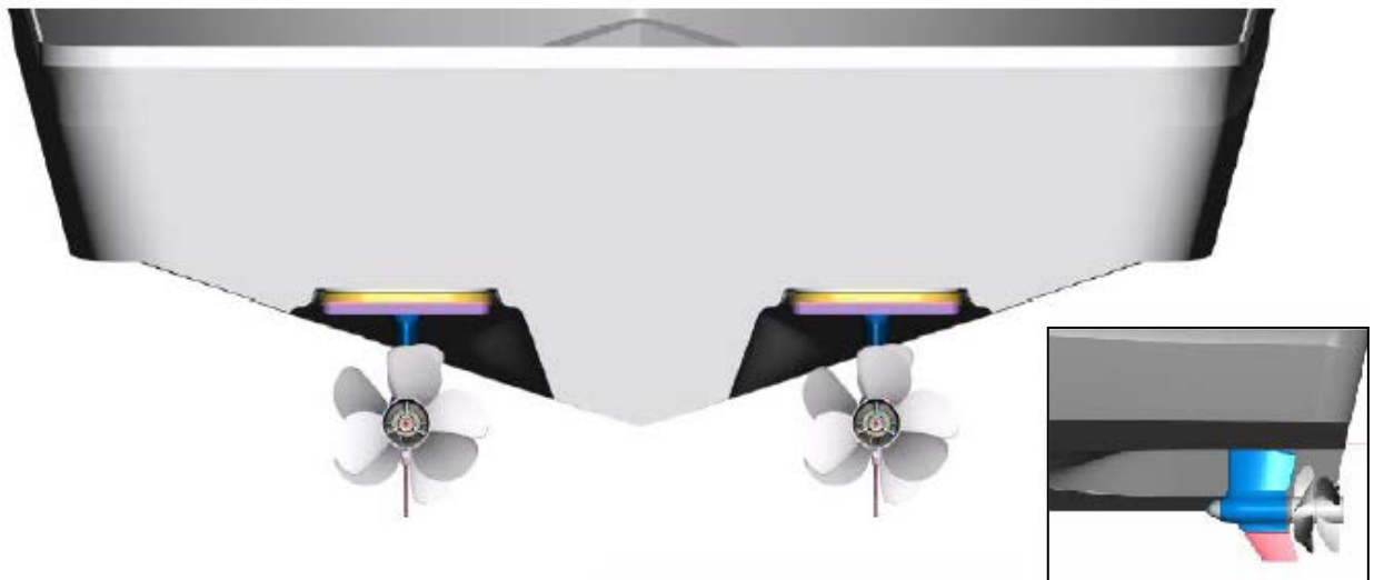
Figura 81. Colocación de los Zeus Pod drives en sus túneles. [80]
