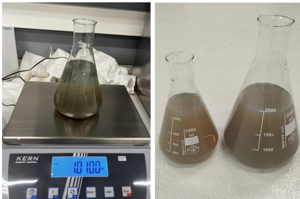
Figura 3-17 Preparación nanofluido de diamantes con \phi_m = 0,0005 (elaboración propia)
