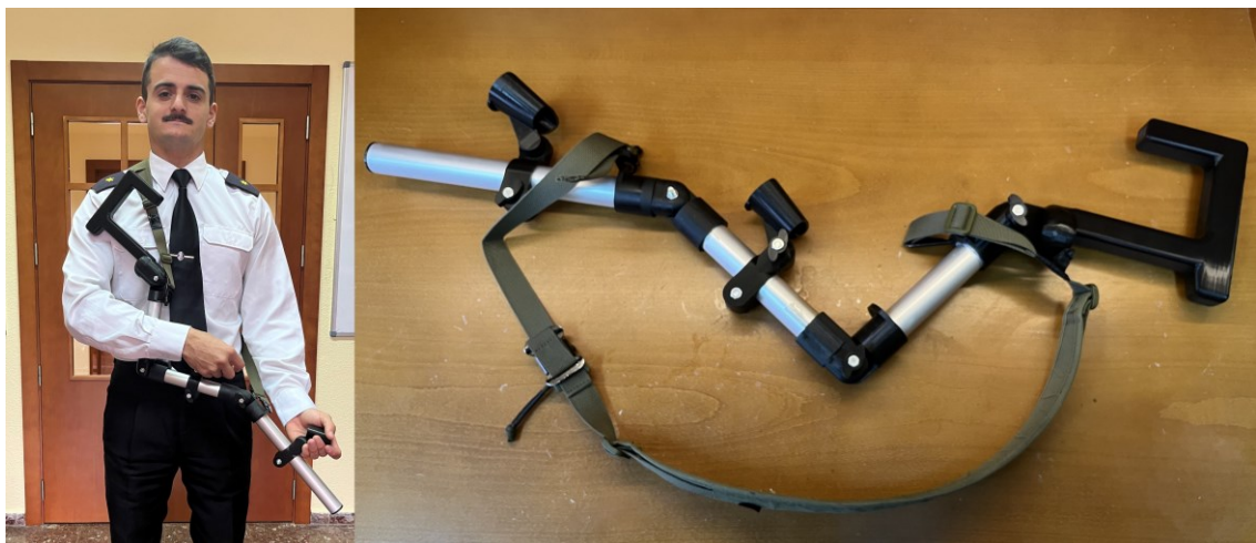
Figura 4-5 Montaje con correa portafusil y colocación
