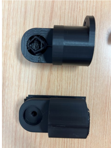
Figura 3-48 Impresión vertical y horizontal de uniones
