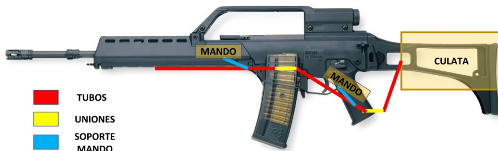
Figura 3-2 Esquema del dispositivo sobre HK G36 E. Autoría propia basada en [19]
