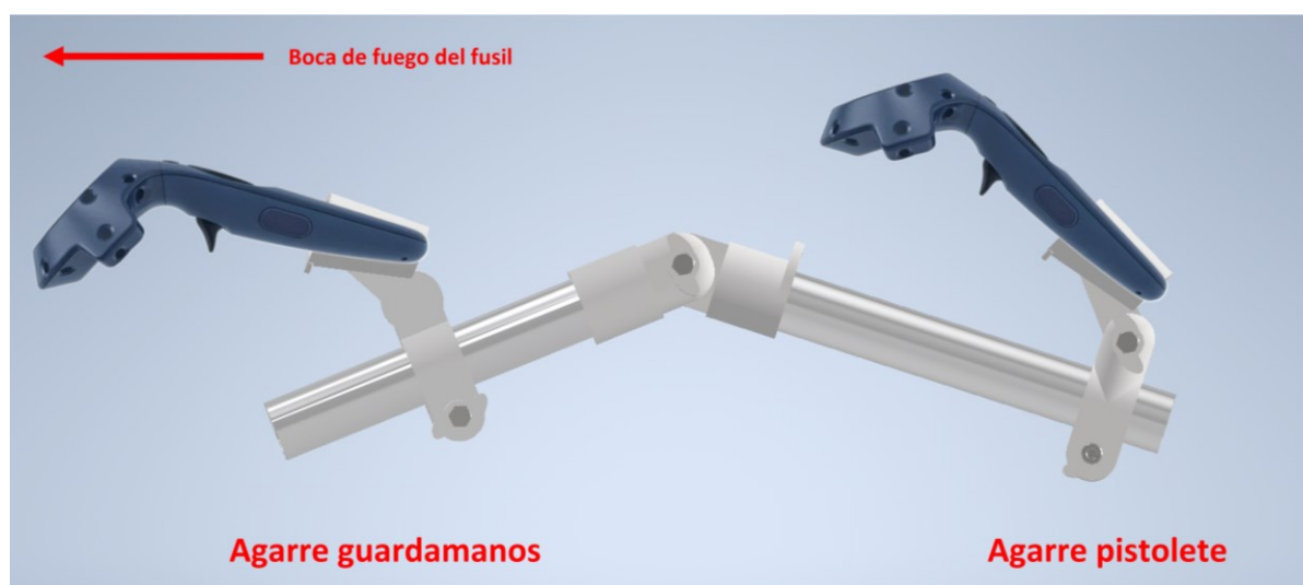
Figura 3-17 Esquema de agarre del dispositivo con mandos
