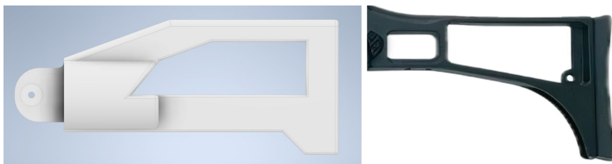
Figura 3-40 Comparativa de la culata alternativa y la del HK
