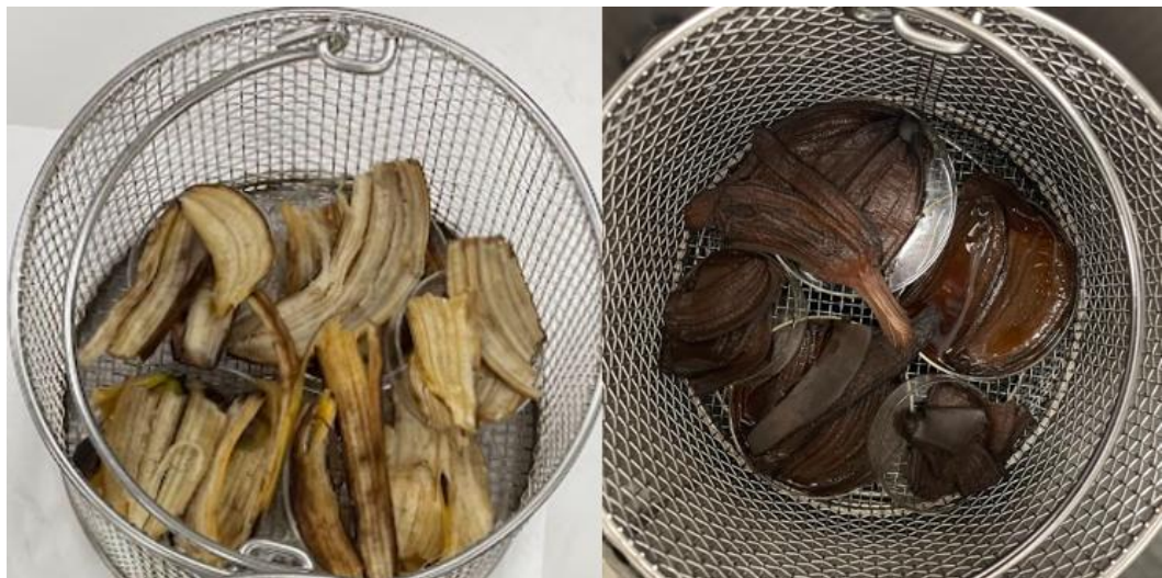
Figura 3-13 Cáscara de plátano antes y después de la carbonización hidrotermal
