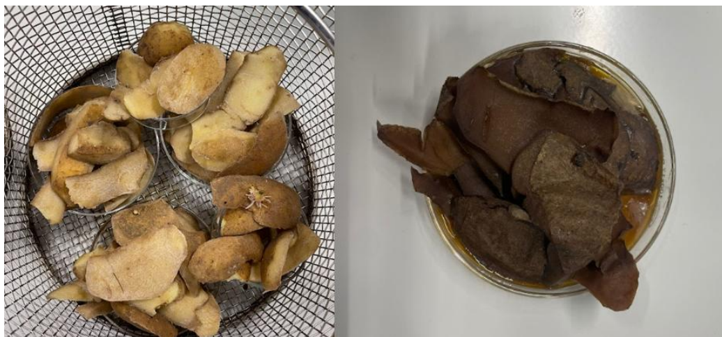
Figura 3-15 Piel de patata antes y después de la carbonización hidrotermal
