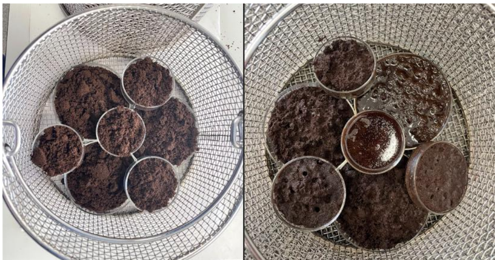
Figura 3-14 Posos de café antes y después de la carbonización hidrotermal
