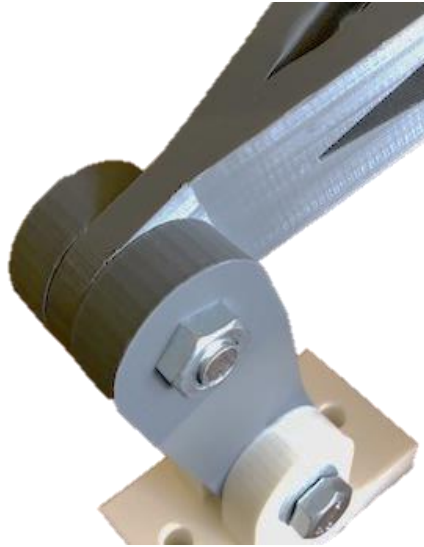
Figura 3-55 Montaje de las Articulaciones [Autoría Propia]
