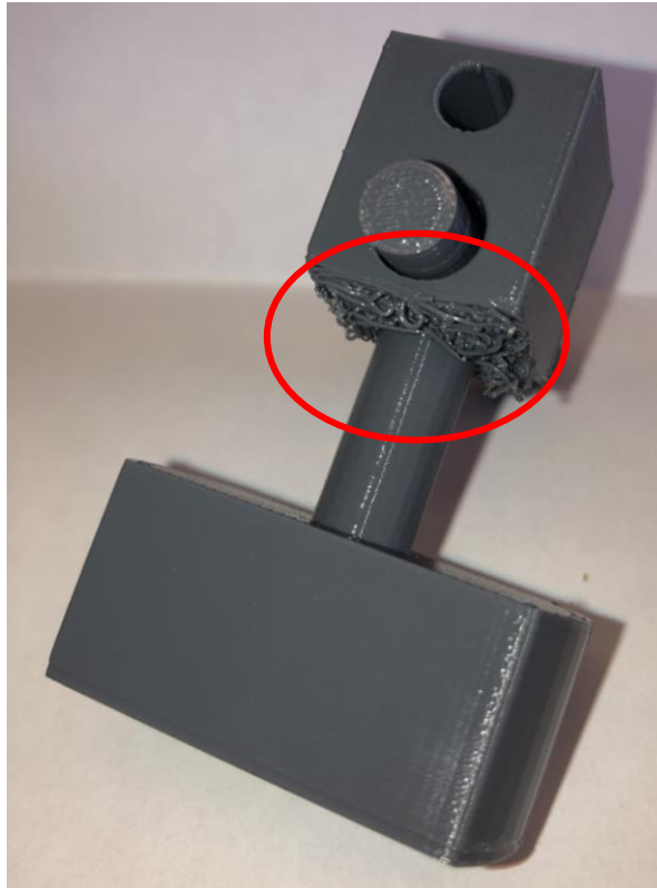
Figura 3-37 Error en soporte de impresión durante primera prueba de impresión [Autoría Propia]
