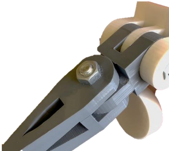
Figura 3-56 Montaje de la Articulación Anterior y el Adaptador Auxiliar [Autoría Propia]
