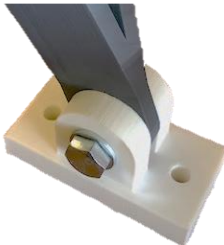
Figura 3-54 Montaje de la Base de Anclaje y la Articulación Posterior [Autoría Propia]
