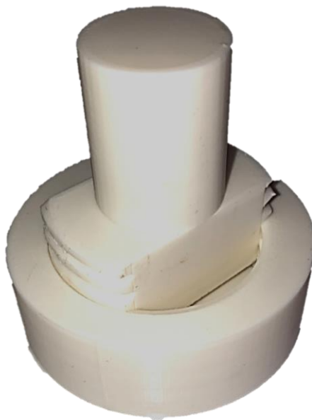
Figura 3-39 Rosca interior y exterior en tercera prueba de impresión [Autoría Propia]
