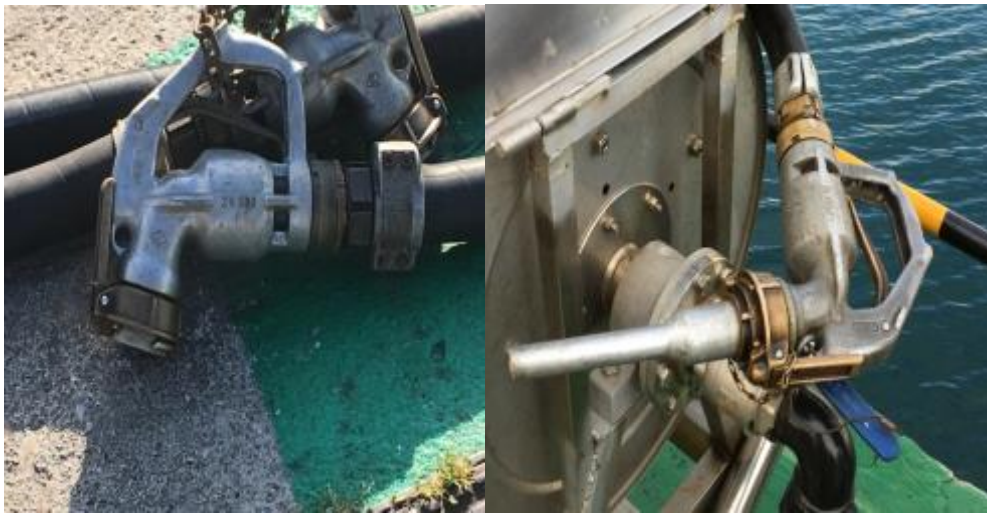
Figura 3-15 Pistola con y sin boquerel
