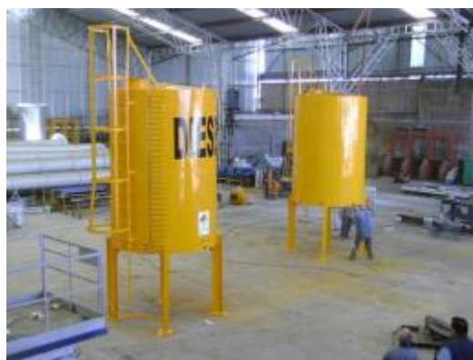
Figura 1-10 Tanques atmosféricos para diésel de poca capacidad [26]
