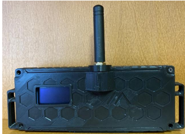
Figura 2-16. Funda impresa en 3D para adaptarla al campo.
