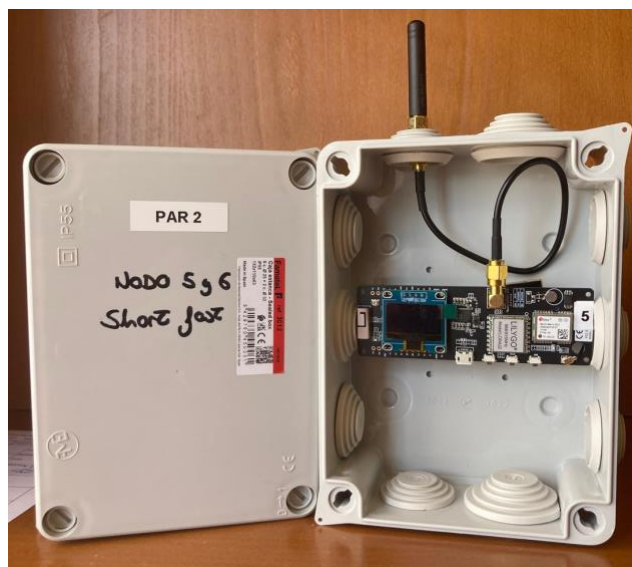
Figura 4-4. Hardware montado para el proyecto. Autoría propia.
