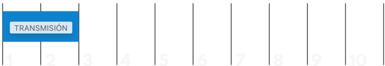
Figura 3-5. Ejemplificación de un Ciclo de trabajo del 20% [47].
