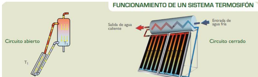
Figura 2-3 Funcionamiento de un sistema de termosifón [2]
