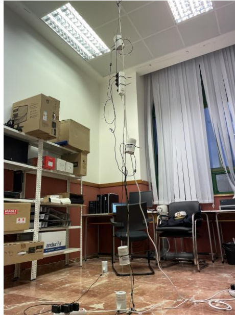
Figura 3-13 Disposición fija de los medidores verticales
