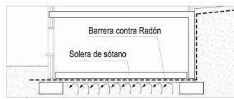
Figura 2-7 Barrera de protección contra el radón situada por debajo de la solera [19]
