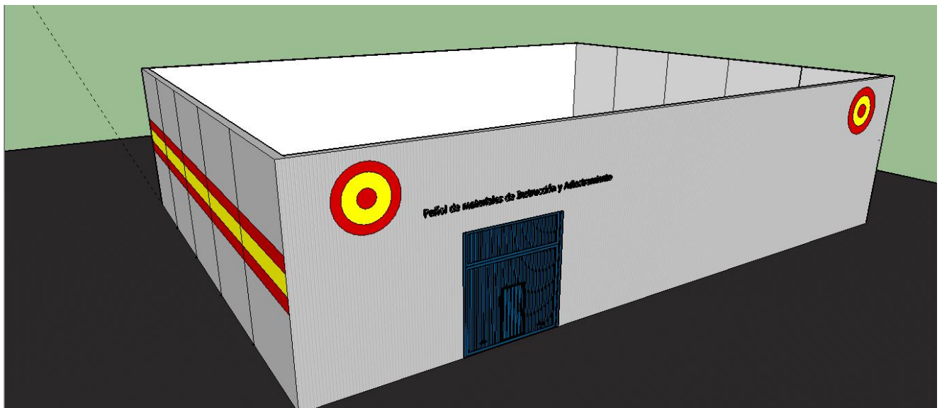
Ilustración 3-13 Conjunto de cerramientos de la nave industrial [Autoría propia]
