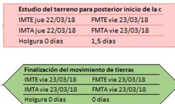
Ilustración 3-38 Componentes del diagrama de red correspondientes al movimiento de tierras (2) [Autoría propia]
