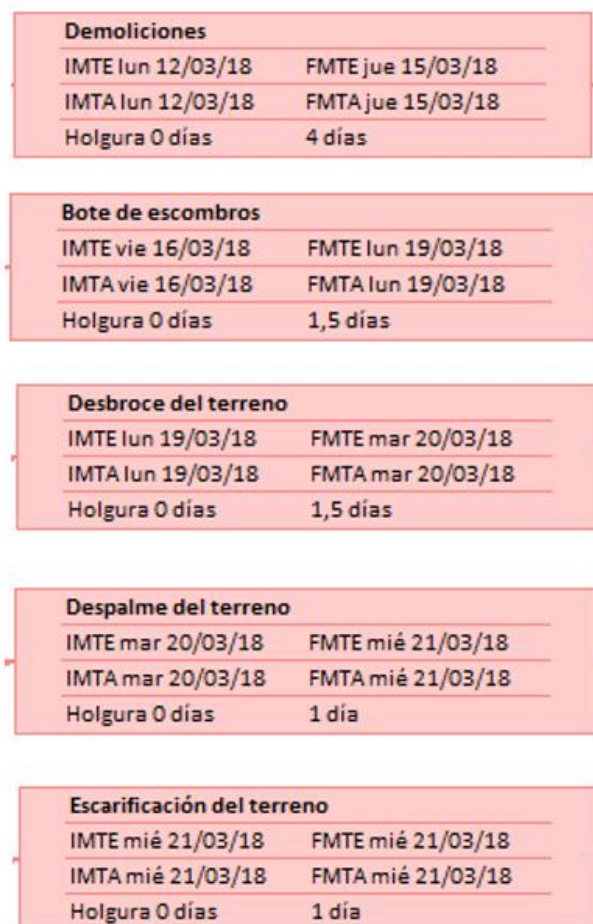
Ilustración 3-37 Componentes del diagrama de red correspondiente al movimiento de tierras (1) [Autoría propia]
