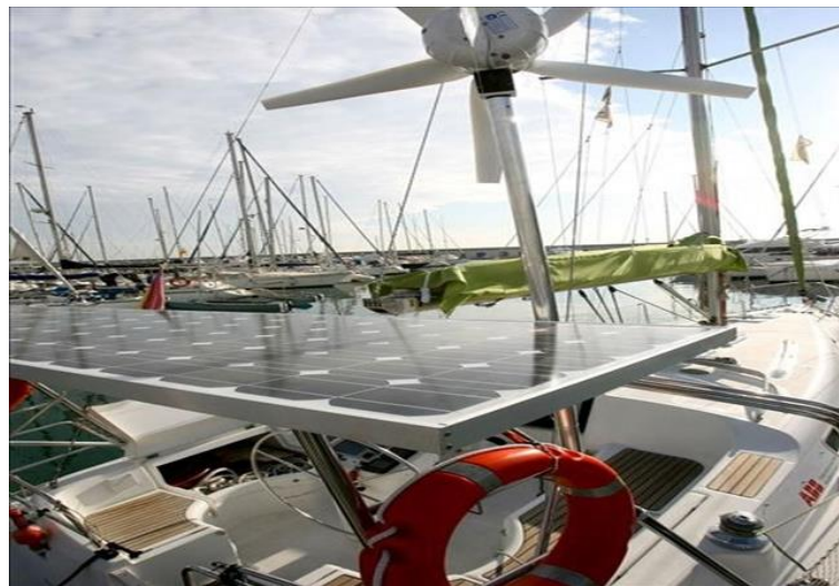
Figura 1-3: Velero 100% eléctrico alimentado por generadores de ER
