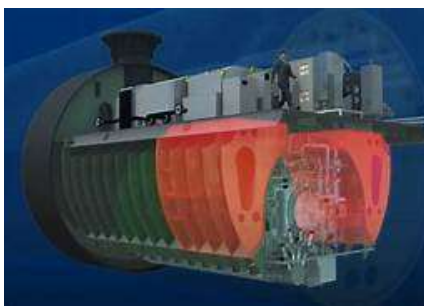
Figura 2-3: Sistema AIP por reformado de Metanol en los submarinos S-80 [28].
