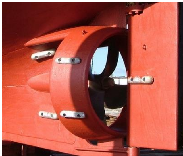
Figura 2-4 Ducted Propeller. Hélice de tobera. [5]
