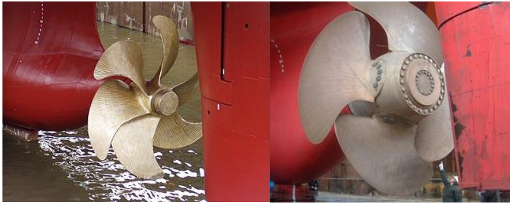
Figura 2-1 Fixed Propeller. Izquierda, hélice en bloque. Derecha, Hélice Por partes [5]
