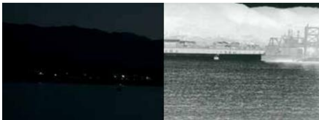
Figura 2.11 Comparativa de imágenes del espectro visible e infrarrojo de una cámara FLIR en la mar [30]
