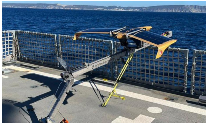
Figura 2-27 M5D Airfox en su lanzadera [87]
