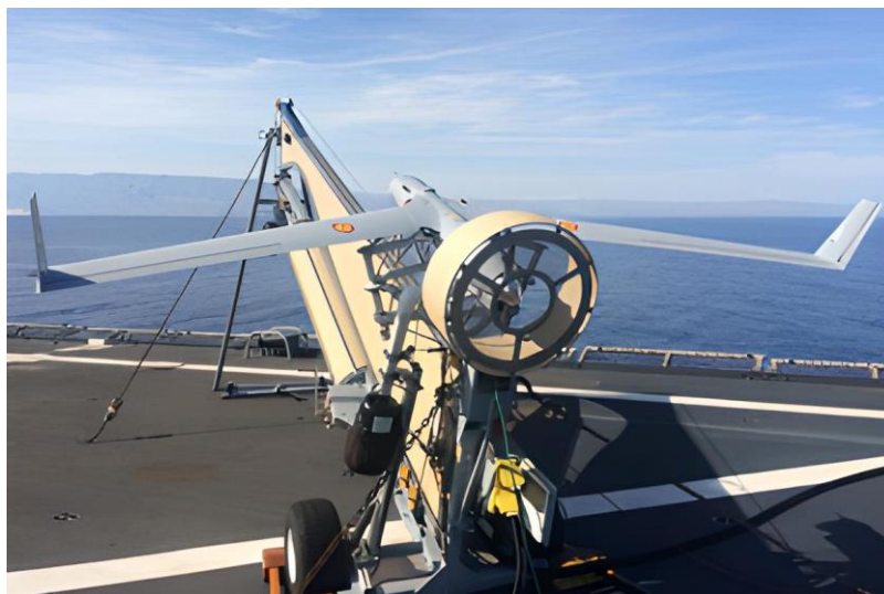
Figura 2-26 Scan Eagle en plataforma de lanzamiento [83]
