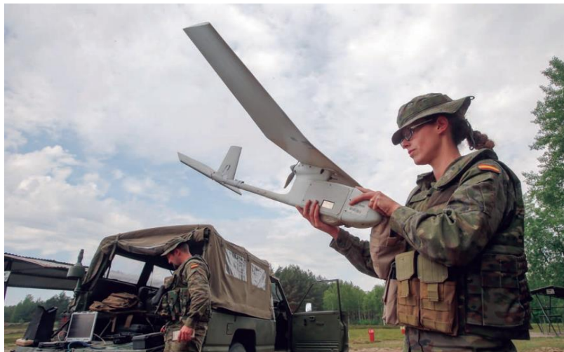
Figura 2-18 Preparación de Raven para su despliegue [53]
