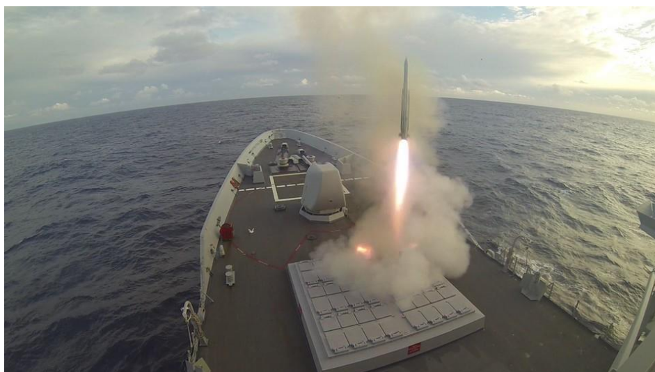
Figura 3-10 MK-41 de una F-100 durante el lanzamiento de un ESSM [92]
