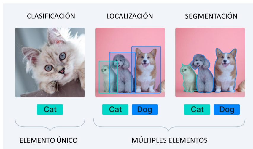
Figura 2-5 Diferencia gráfica entre las tareas de clasificación, localización y segmentación [16]
